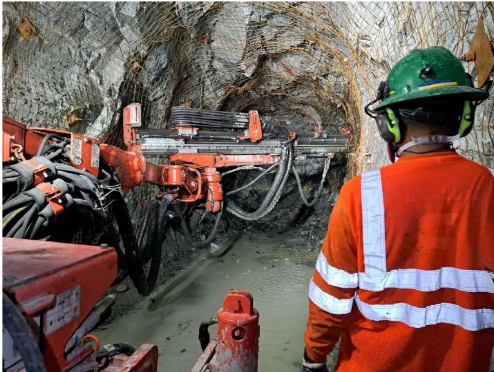
Figura 5. Equipo Jumbo J-37 en perforación
