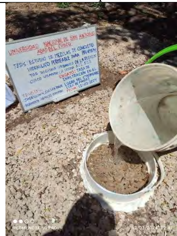
Ensayo infiltración del concreto permeable
