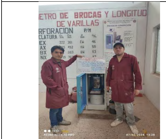
Ensayo resistencia a compresión del concreto
