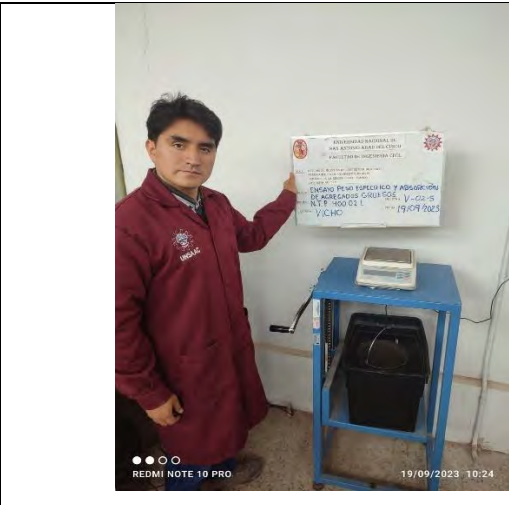
Ensayo peso específico y absorción (Peso muestra sumergida)
