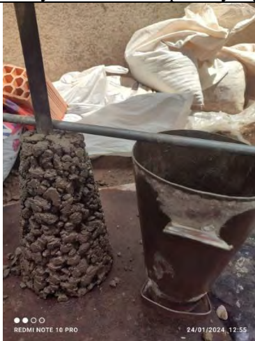
Ensayo "slump" del concreto permeable
