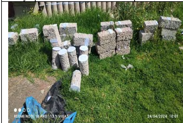
Muestras ensayadas del concreto permeable
