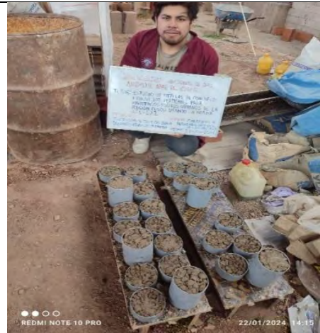
Muestras ensayo cantabro y permeabilidad
