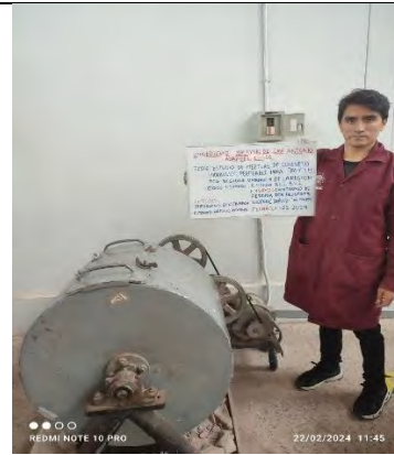
Ensayo cantabro concreto permeable
