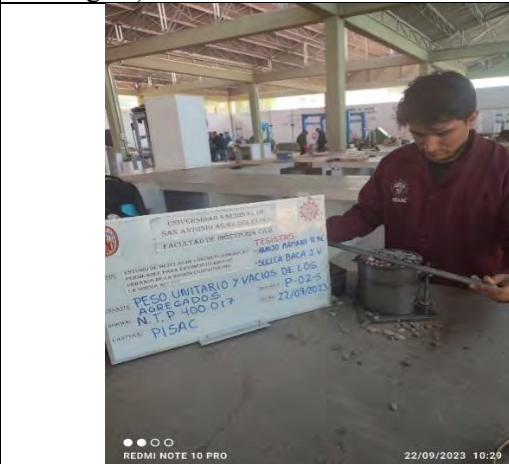
Ensayo peso unitario y vacíos de los agregados
