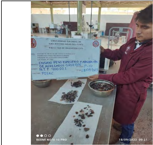
Ensayo peso específico y absorción (muestra saturada superficialmente seca)
