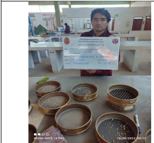
Ensayo análisis granulométrico de los agregados
