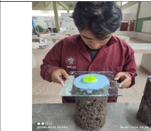
Refrentado con yeso del concreto
