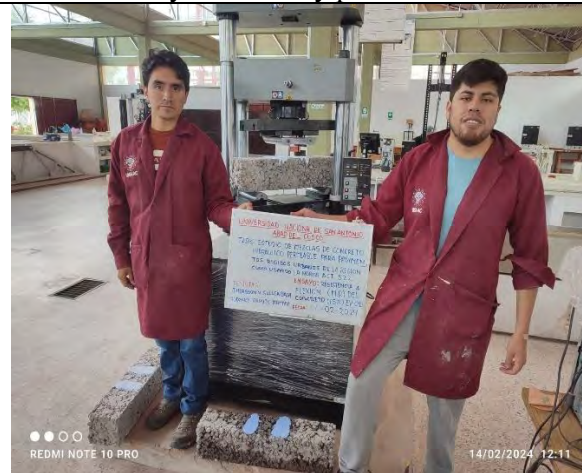
Muestras ensayo cantabro y permeabilidad
