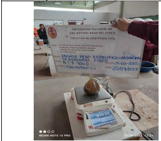
Ensayo peso específico y absorción del agregado fino
