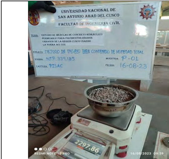
Ensayo contenido de humedad del agregado grueso
