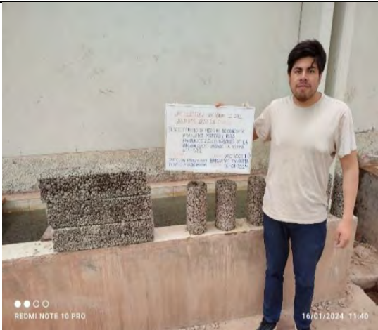
Desencofrado y curado de briquetas y viguetas
