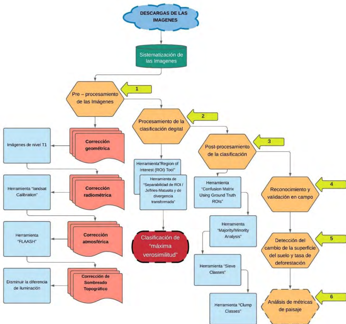
Figura 5. Diagrama del procesamiento de las imágenes satelitales, incluye la aplicación del análisis de métricas del paisaje.
