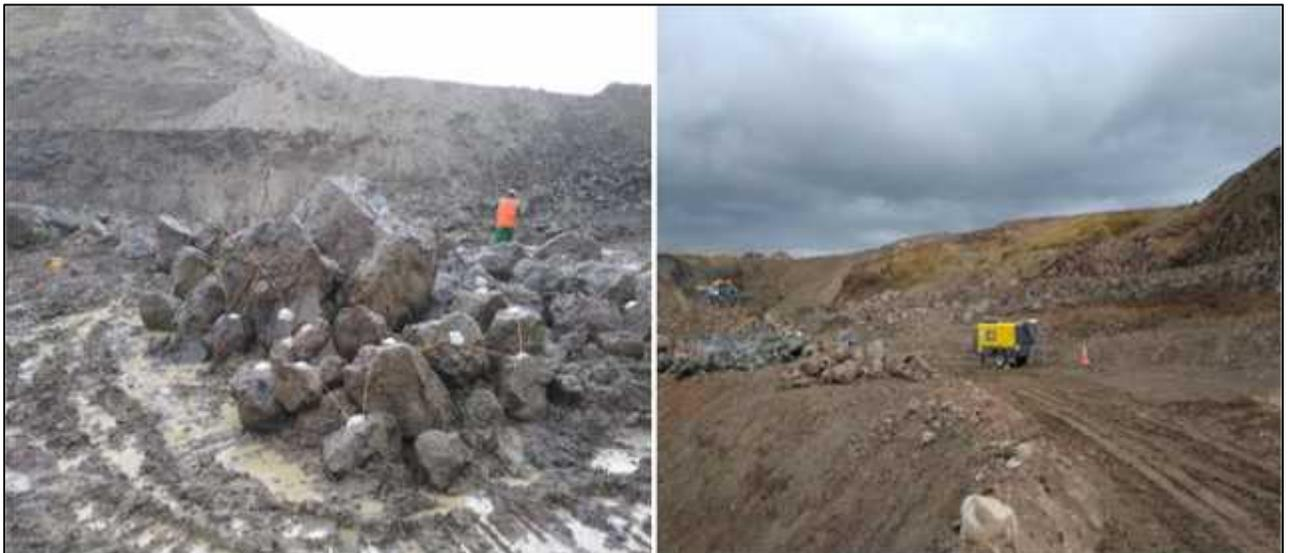
*Fuente: Elaboración propia. En ambas imágenes se observa bancos mayores a un promedio de 16 pulgadas, los cuales serán reducidos mediante voladura secundaria, en la imagen izquierda se realiza el plasteo y, en la imagen derecha cachorro.*
