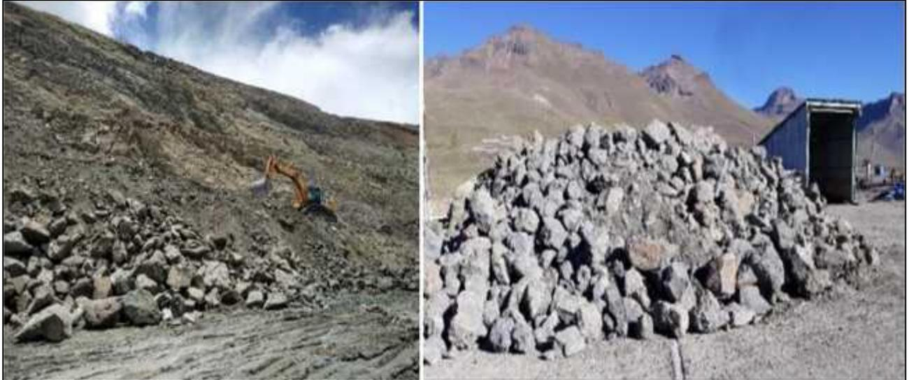
*Fuente: Elaboración propia. En la imagen izquierda observamos una excavadora seleccionando bancos mayores a un diámetro promedio de 16 pulgadas y, en la imagen derecha se visualiza un apilamiento de bancos seleccionados en cancha de gruesos para ser reducido por el equipo rompebanco.*
