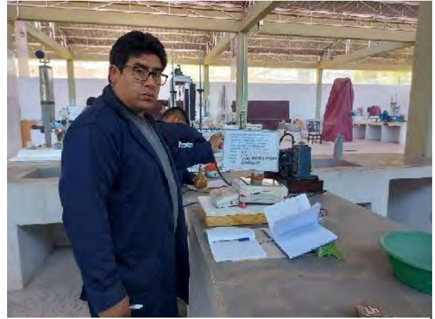
Imagen 21: pesado de muestras de contenido de humedad.
