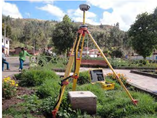
Imagen 7: Posicionamiento del Equipo Geodésico GNSS (base)
