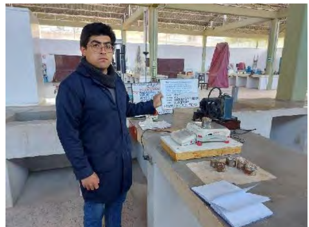
Imagen 20: Pesado de muestras de límites de consistencia.
