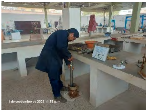
Imagen 19: Compactación para CBR.
