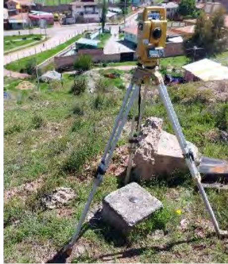
imagen 13: Nivelación Trigonométrica con Estación Total.
