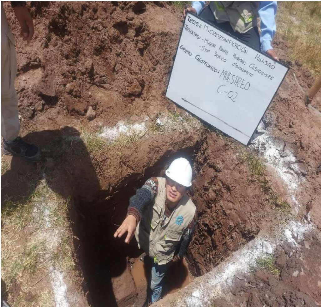
Figura. 75: Tallado de muestra inalterada en forma cúbica
