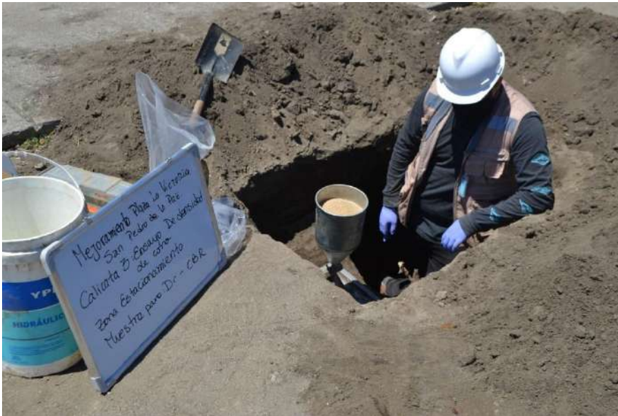
Figura. 15: Ensayo de densidad natural mediante cono de arena
