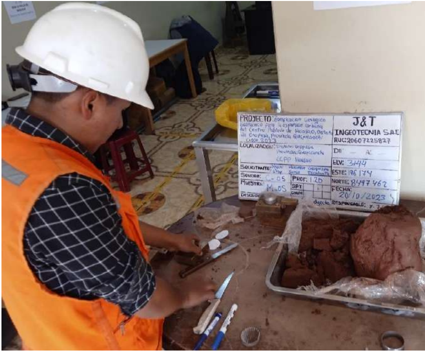
Figura. 90: Colocación de muestra remoldeada en caja de corte
