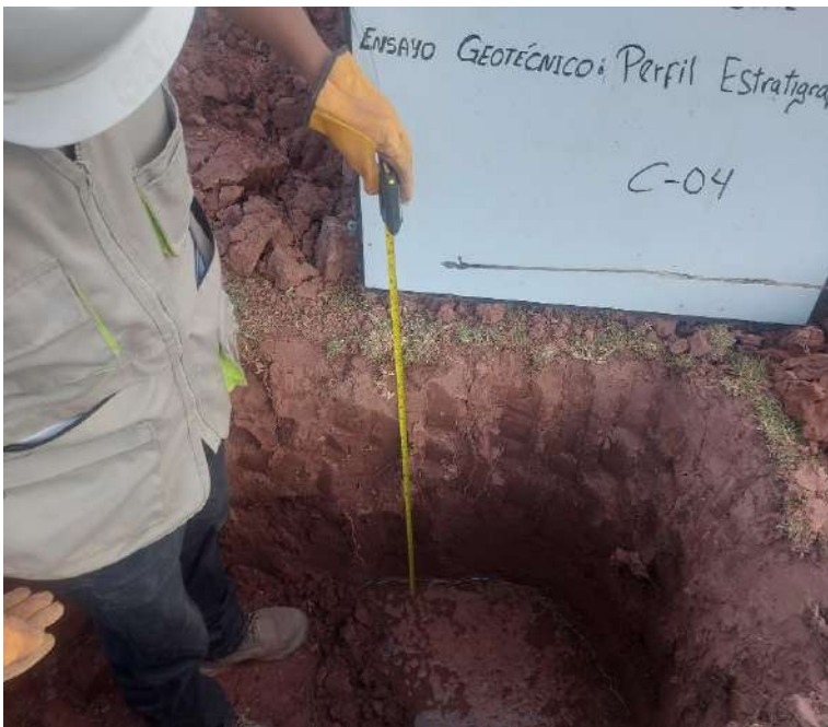
Figura. 73: Perfil estratigráfico con presencia de agua a menos de 1 metro
