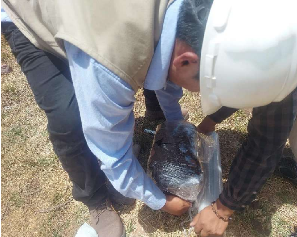
Figura. 76: Embalaje de muestra inalterada luego de parafinado en fill
