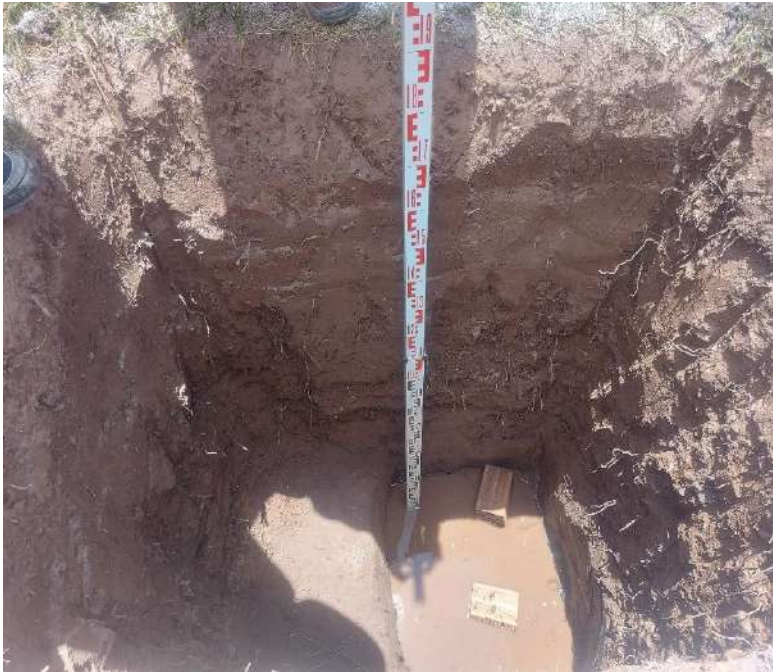
Figura. 72: Perfil estratigráfico con presencia de nivel freático
