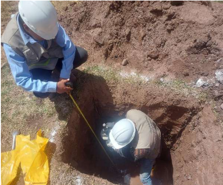
Figura. 79: Ensayo DPL dentro de la calicata para alcanzar mayor profundidad
