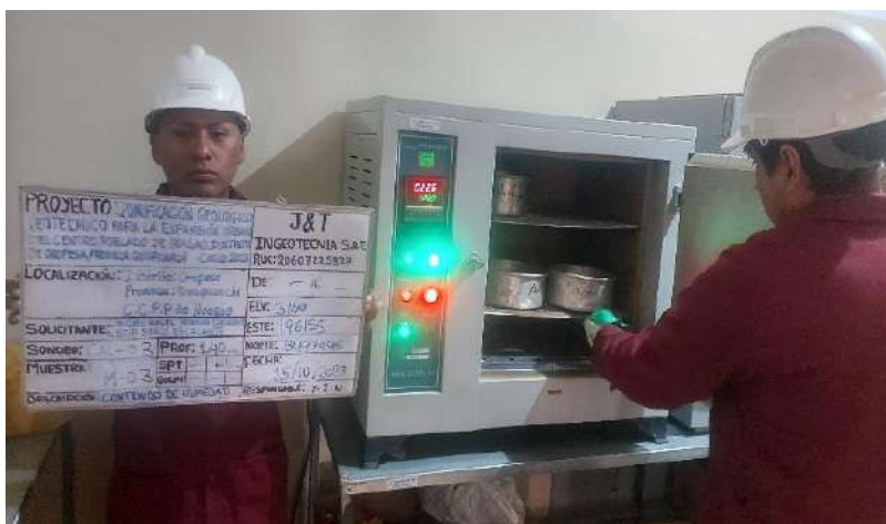
Figura. 84: Colocación de muestra de suelo en el horno por 24 horas
