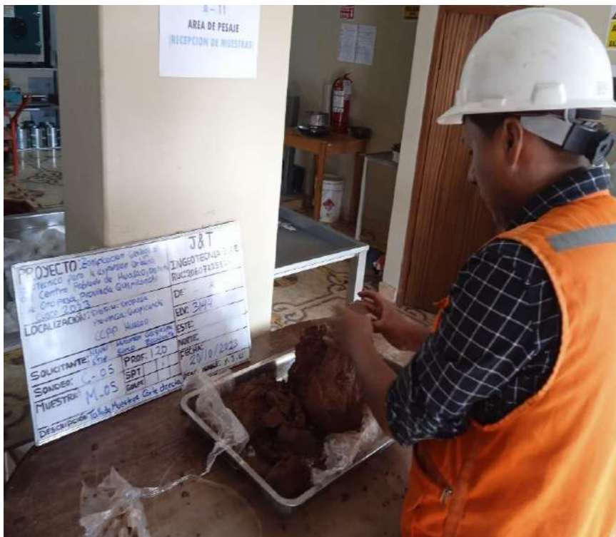
Figura. 89: Remoldeado de muestra inalterada para ensayo de corte directo
