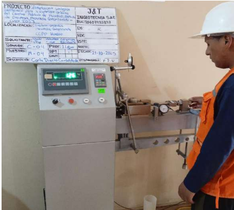
Figura. 92: Ensayo de corte directo del tipo consolidado-drenado
