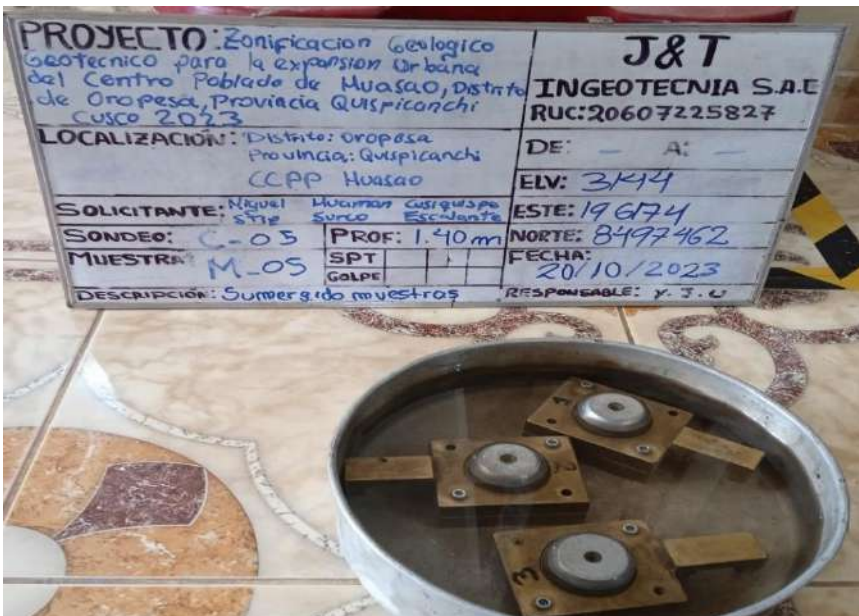
Figura. 91: Sumergido de muestras remoldeadas en caja de corte hasta que se sature totalmente
