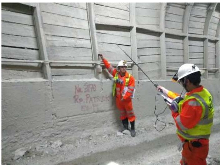
Ilustración 1. Medición en el ingreso de aire de la bocamina Rampa Patrick, nivel 3170
