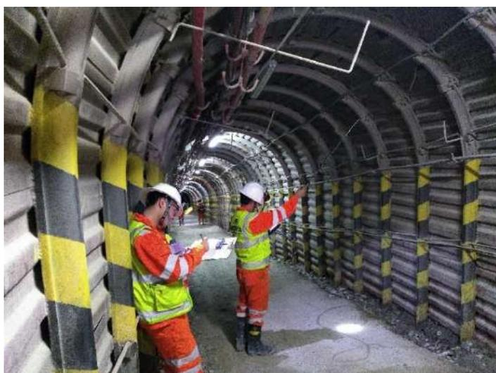
Ilustración 3. Medición en el ingreso de aire de la bocamina Rampa Paralela, nivel 3170
