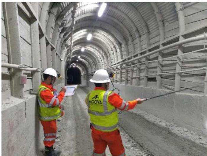
Ilustración 2. Medición en el ingreso de aire de la bocamina Rampa Patrick, nivel 3170
