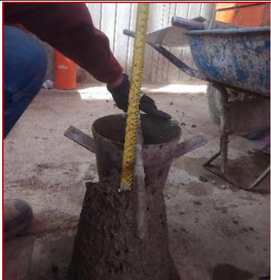
Medición de la consistencia de la mezcla de concreto patrón de f'c=210 kg/cm 2
