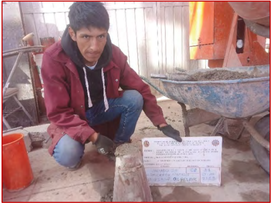
Ensayo de consistencia de la mezcla de concreto patrón de f'c=210 kg/cm 2
