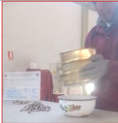
Ensayo de abrasión de los ángeles del agregado grueso (MTC E207)
