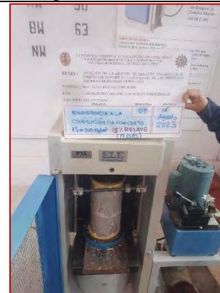
Ensayo de resistencia a la compresión de concreto f'_c=210 \text{ kg/cm}^2 + 15\% \text{ ARM (14 días)}
