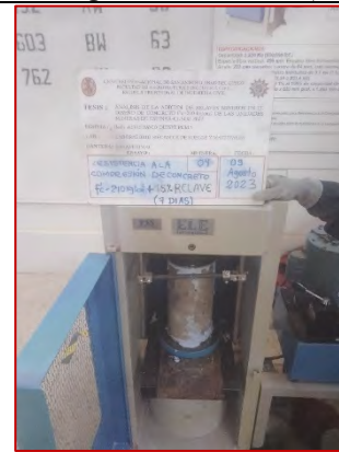
Ensayo de resistencia a la compresión de concreto f'c=210 \text{ kg/cm}^2 + 15\% \text{ ARM} (7 días)
