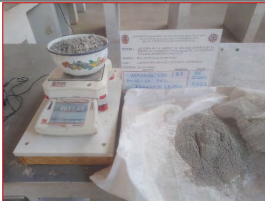
Ensayo de abrasión de los ángeles del agregado grueso (MTC E207)
