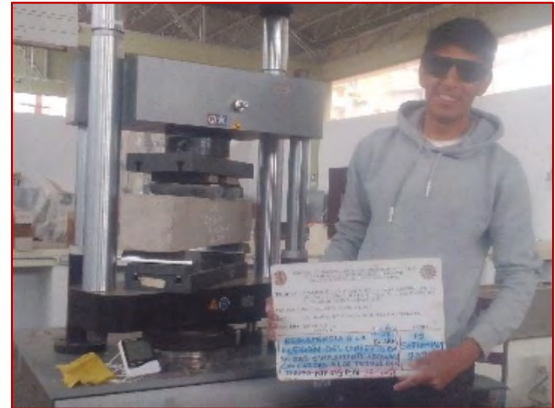
(V03 +5% ARM) Ensayo de resistencia a la flexión de concreto f'_c=210 \text{ kg/cm}^2 + 5\% \text{ ARM} (28 días)
