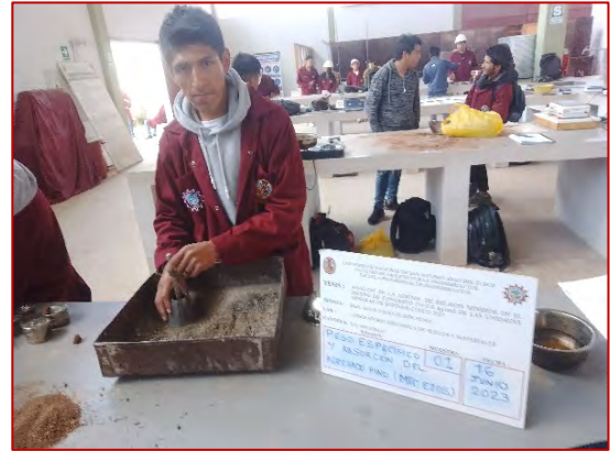
Ensayo de gravedad específica y absorción del agregado fino (MTC E205)
