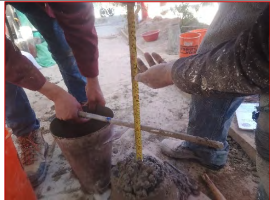
Medición de la consistencia de la mezcla de concreto patrón f'c=210 \text{ kg/cm}^2 + 5% de adición de relave minero
