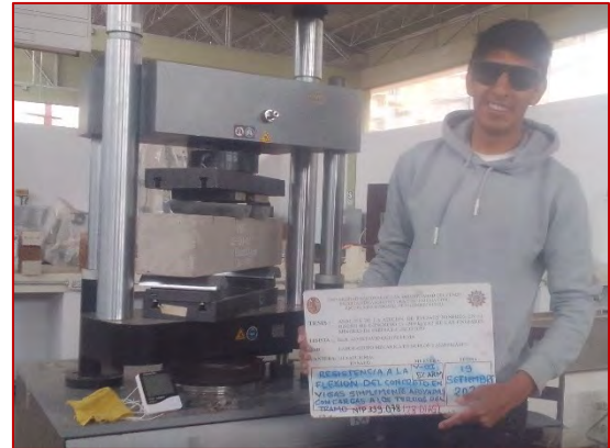
(V01+ 5% ARM) Ensayo de resistencia a la flexión de concreto f'_c=210 \text{ kg/cm}^2 + 5\% \text{ ARM} (28 días)
