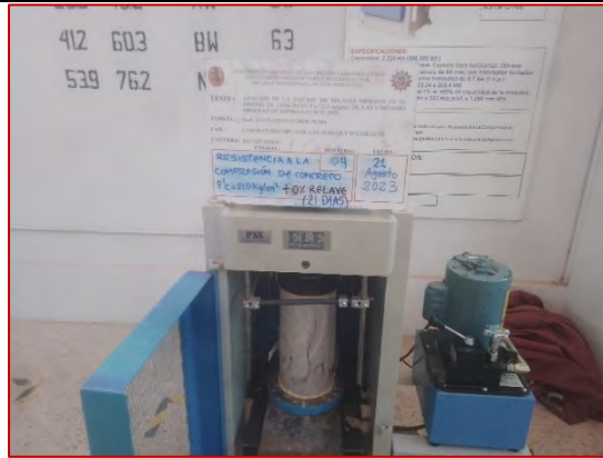
Ensayo de resistencia a la compresión de concreto f'c=210 \text{ kg/cm}^2 + 0\% \text{ ARM} (21días)
