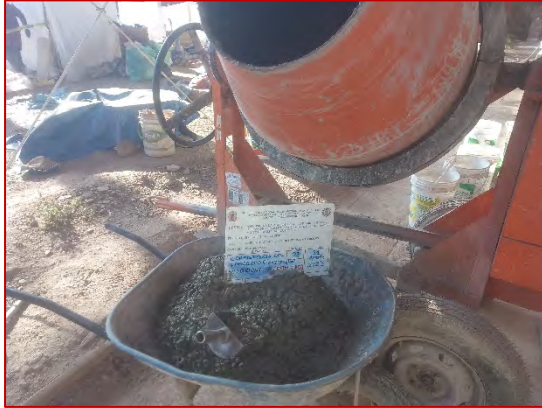
Mezcla de concreto patrón de f'c=210 \text{ kg/cm}^2 para elaboración de 3 vigas
