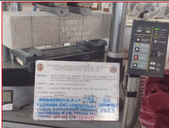
(V03 + 10% ARM) Ensayo de resistencia a la flexión de concreto f'c=210 \text{ kg/cm}^2 + 10\% \text{ ARM} (28 días)
