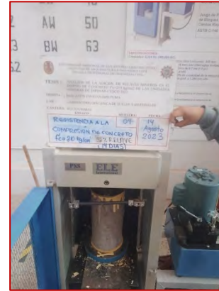
Ensayo de resistencia a la compresión de concreto f'_c=210 \text{ kg/cm}^2 + 5\% \text{ ARM (14 días)}
