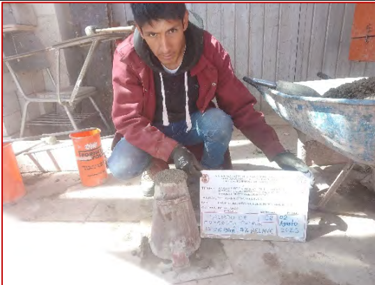
Ensayo de consistencia de la mezcla de concreto patrón f'c=210 \text{ kg/cm}^2 + 5% de adición de relave minero
