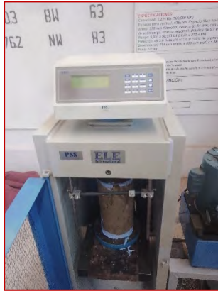
Ensayo de resistencia a la compresión de concreto f'c=210 \text{ kg/cm}^2 + 0\% \text{ ARM} (3 días)
