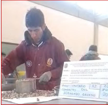
Ensayo de peso unitario compactado y vacíos del agregado grueso (MTC E205)
