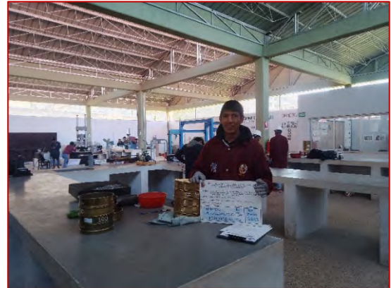
Ensayo de análisis granulométrico del agregado grueso (MTC E204)
