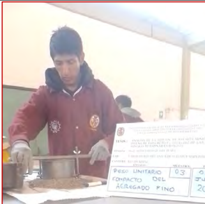
Ensayo de peso unitario compactado y vacíos del agregado fino (MTC E205)
