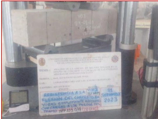
(V03+ 15% ARM) Ensayo de resistencia a la flexión de concreto f'_c=210 \text{ kg/cm}^2 + 15\% \text{ ARM} (28 días)
