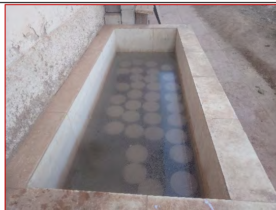
Curado de briquetas en el laboratorio de mecánica de suelos y materiales de la escuela profesional de Ingeniería Civil
