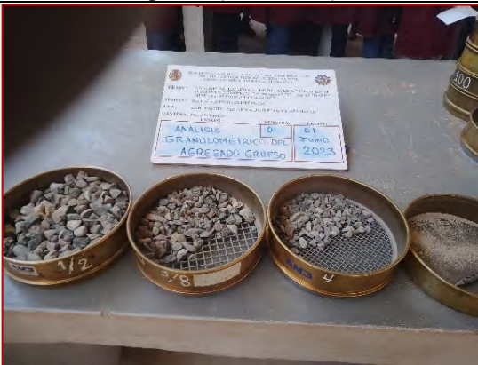
Ensayo de análisis granulométrico del agregado grueso (MTC E204)
