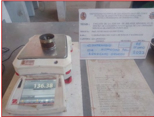
Ensayo de contenido de humedad del agregado grueso (MTC E108)
