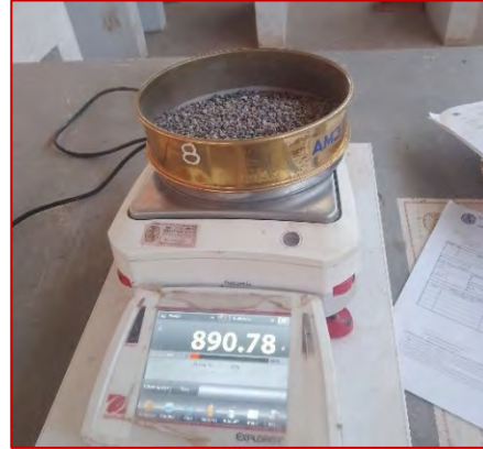
Ensayo de análisis granulométrico del agregado fino (MTC E204)
