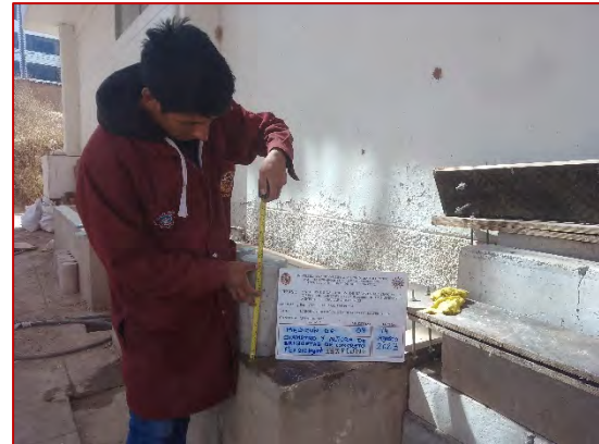
Control de la altura de las briquetas en estudio de esta investigación
