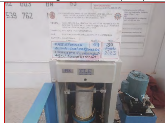
Ensayo de resistencia a la compresión de concreto f'c=210 \text{ kg/cm}^2 + 15\% \text{ ARM} (28días)
