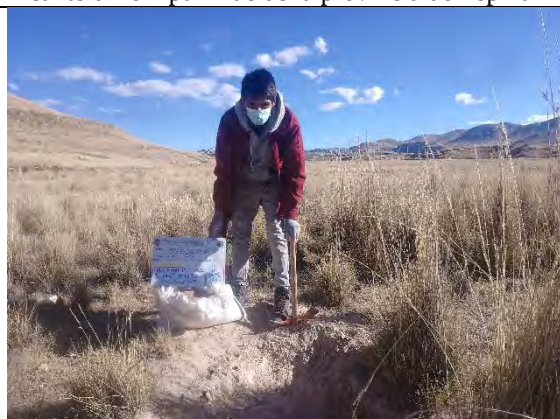
Embolsado y traslado de relave minero del relave minero Ccamacmayo de la provincia de Espinar
