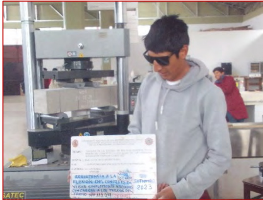
(V01+ 10% ARM) Ensayo de resistencia a la flexión de concreto f'c=210 \text{ kg/cm}^2 + 10\% \text{ ARM} (28 días)
