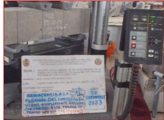
(V02 +10% ARM) Ensayo de resistencia a la flexión de concreto f'c=210 \text{ kg/cm}^2 + 10\% \text{ ARM} (28 días)
