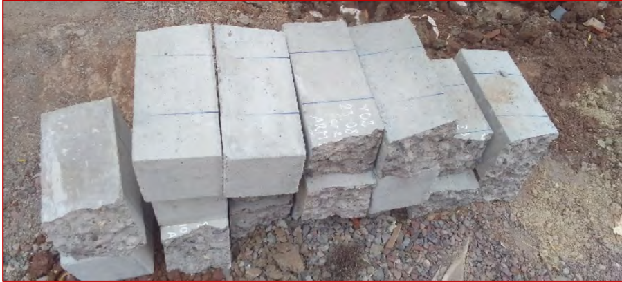
12 muestras ensayas en laboratorio para la resistencia a la flexión según el método ASTM C78
