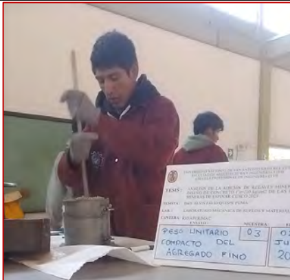
Ensayo de peso unitario compactado y vacíos del agregado fino (MTC E205)
