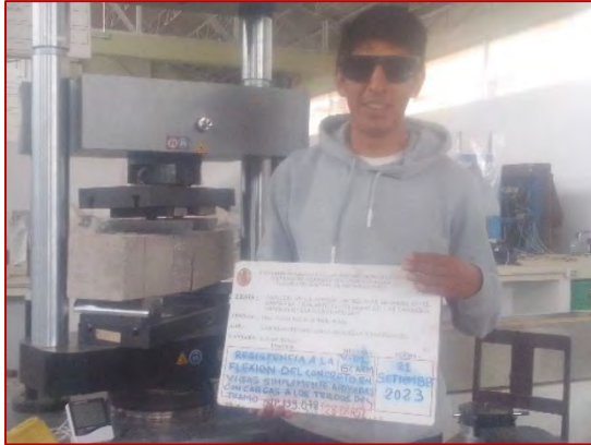
(V01+ 15% ARM) Ensayo de resistencia a la flexión de concreto f'_c=210 \text{ kg/cm}^2 + 15\% \text{ ARM} (28 días)
