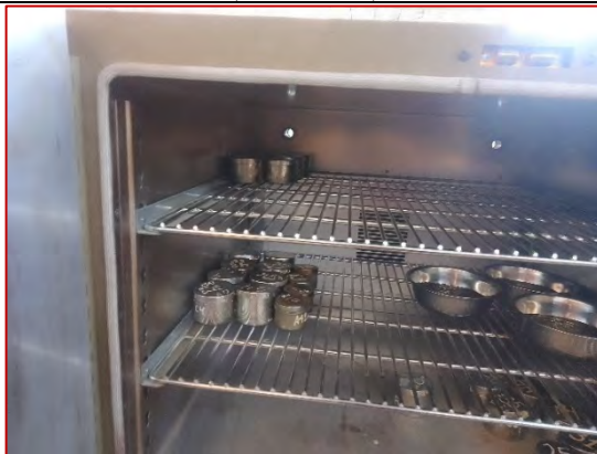
Ensayo de contenido de humedad del agregado grueso (MTC E108)
