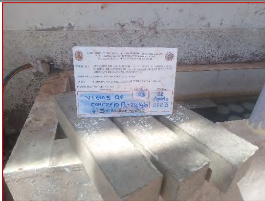
Muestras de 3 vigas de concreto patrón de f'c=210 \text{ kg/cm}^2 + 5% de adición de relave minero
