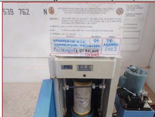
Ensayo de resistencia a la compresión de concreto f'c=210 \text{ kg/cm}^2 + 0\% \text{ ARM} (28días)
