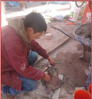
Sacado del cono de Abrams en forma perpendicular de la mezcla de concreto patrón de f'c=210 kg/cm 2
