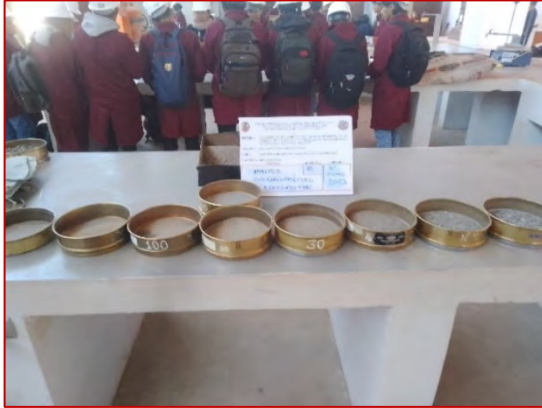
Ensayo de análisis granulométrico del agregado fino (MTC E204)
