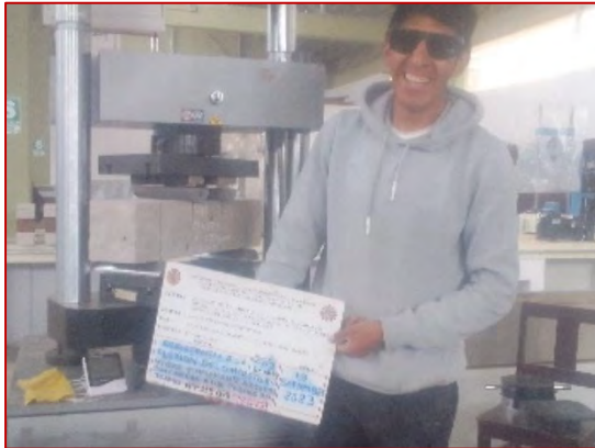
(V02 + 5% ARM) Ensayo de resistencia a la flexión de concreto f'_c=210 \text{ kg/cm}^2 + 5\% \text{ ARM} (28 días)
