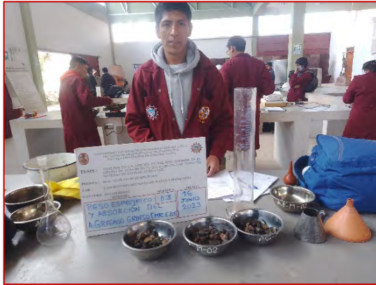
Ensayo de peso específico y absorción del agregado grueso (MTC E206)
