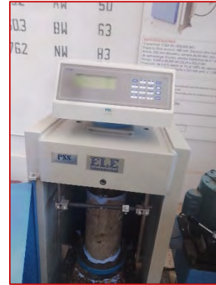
Ensayo de resistencia a la compresión de concreto f'c=210 \text{ kg/cm}^2 + 5\% \text{ ARM} (3 días)
