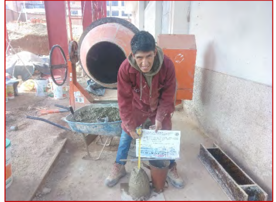
Ensayo de consistencia del diseño de mezcla de concreto patrón de f'c=210 \text{ kg/cm}^2 + 10% de adición de relave minero
