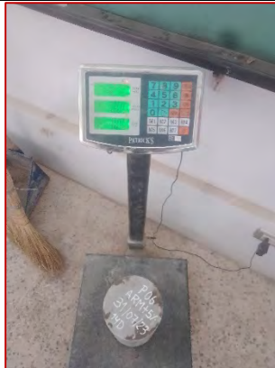
Control de peso de las briquetas en estudio de esta investigación
