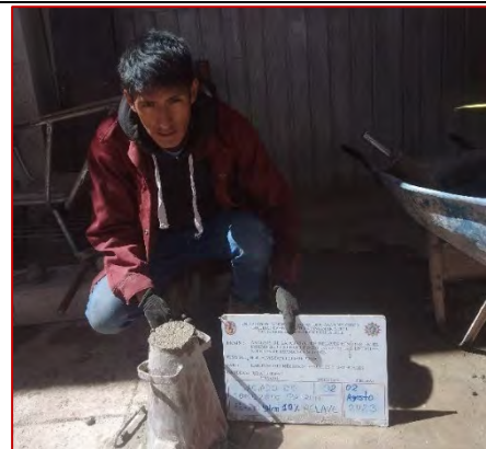
Ensayo de consistencia de la mezcla de concreto patrón f'c=210 \text{ kg/cm}^2 + 10% de adición de relave minero
