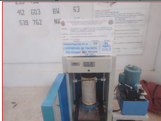
Ensayo de resistencia a la compresión de concreto f'_c=210 \text{ kg/cm}^2 + 5\% \text{ ARM (21 días)}
