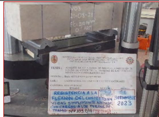
(V03 + 0% ARM) Ensayo de resistencia a la flexión de concreto f'c=210 \text{ kg/cm}^2 + 0\% \text{ ARM} (28 días)
