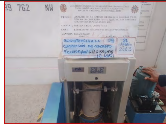
Ensayo de resistencia a la compresión de concreto f'c=210 \text{ kg/cm}^2 + 10\% \text{ ARM} (21días)
