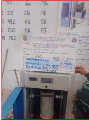
Ensayo de resistencia a la compresión de concreto f'_c=210 \text{ kg/cm}^2 + 10\% \text{ ARM (14 días)}
