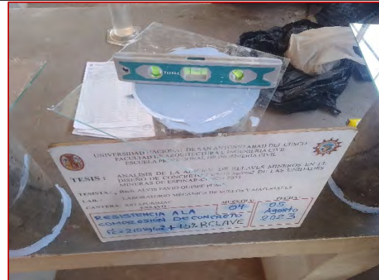
Colocación de caping a las briquetas en estudio de esta investigación
