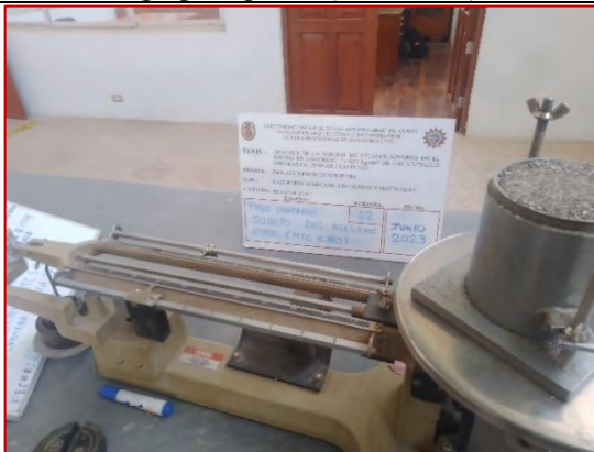
Ensayo de peso unitario suelto y vacíos del agregado fino (MTC E205)
