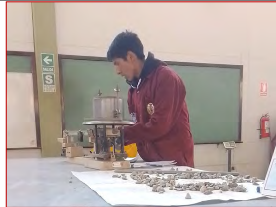
Ensayo de peso unitario suelto y vacíos del agregado grueso (MTC E205)
