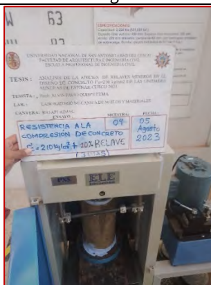
Ensayo de resistencia a la compresión de concreto f'c=210 \text{ kg/cm}^2 + 10\% \text{ ARM} (3 días)
