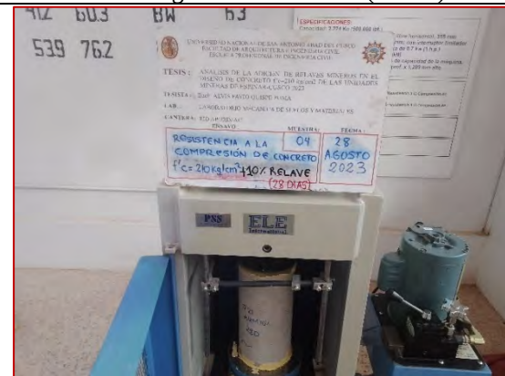
Ensayo de resistencia a la compresión de concreto f'c=210 \text{ kg/cm}^2 + 10\% \text{ ARM} (28días)
