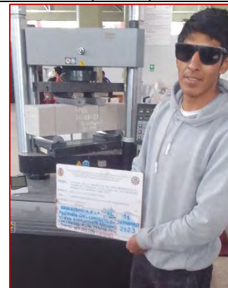
(V01 + 0% ARM) Ensayo de resistencia a la flexión de concreto f'c=210 \text{ kg/cm}^2 + 0\% \text{ ARM} (28 días)
