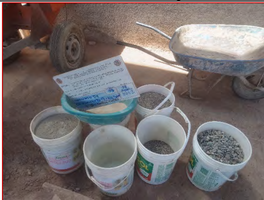
Componentes para la elaboración de 3 vigas de concreto patrón de f'c=210 \text{ kg/cm}^2 + 5% de adición de relave minero
