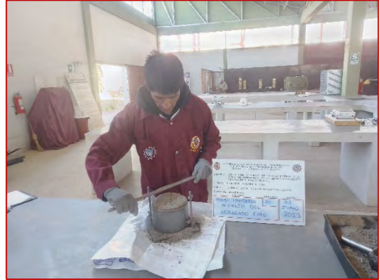
Ensayo de peso unitario suelto y vacíos del agregado fino (MTC E205)
