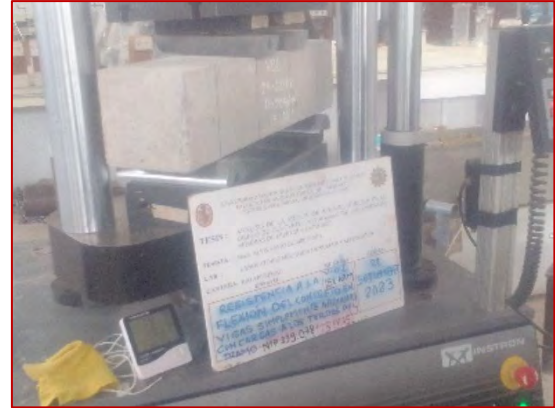
(V02 + 15 % ARM) Ensayo de resistencia a la flexión de concreto f'_c=210 \text{ kg/cm}^2 + 15\% \text{ ARM} (28 días)
