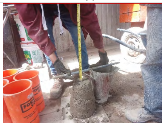
Medición de la consistencia de la mezcla de concreto patrón f'c=210 \text{ kg/cm}^2 + 15% de adición de relave minero
