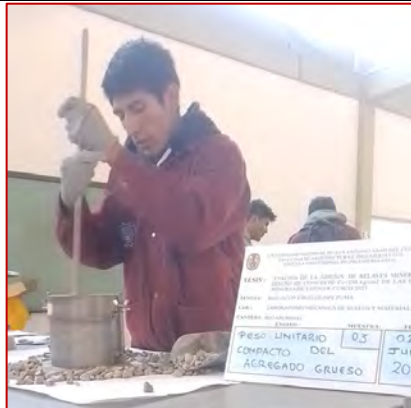
Ensayo de peso unitario compactado y vacíos del agregado grueso (MTC E205)
