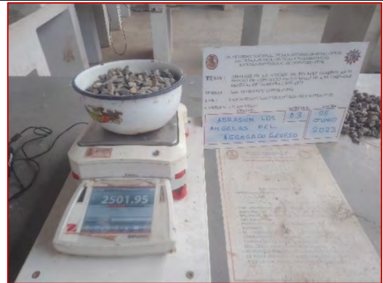
Ensayo de abrasión de los ángeles del agregado grueso (MTC E207)
