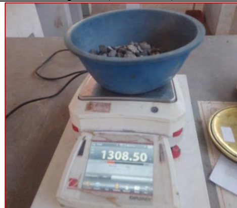
Ensayo de análisis granulométrico del agregado grueso (MTC E204)
