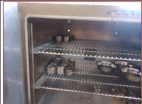
Ensayo de contenido de humedad del agregado fino (MTC E108)
