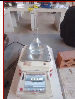
Ensayo de gravedad específica y absorción del agregado fino (MTC E205)
