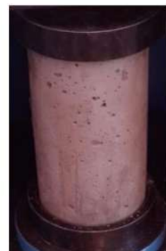
TIPO DE FALLA: 4
