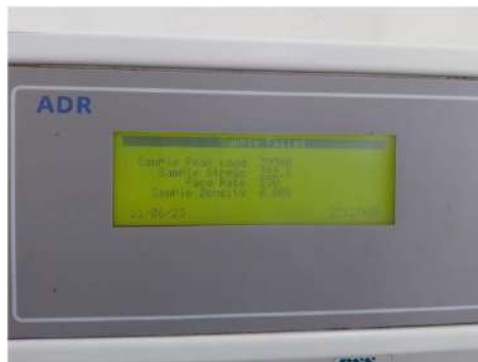
CARGA DE ROTURA: 39340 kg
