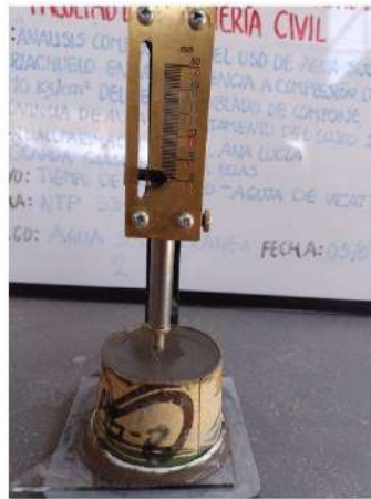
Penetración a la muestra de agua subterránea
