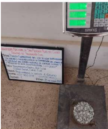
Peso proctor + muestra compactada 1: 9700 g
