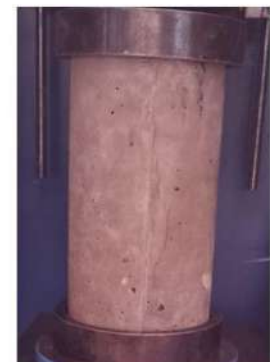
TIPO DE FALLA: 3
