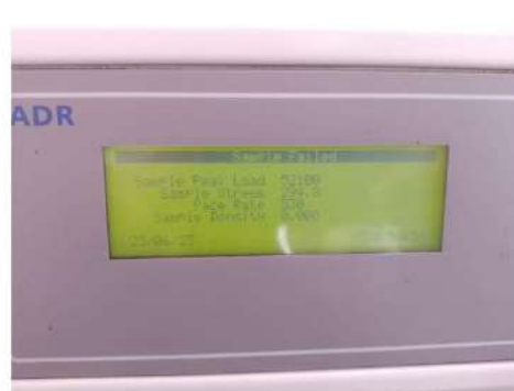
CARGA DE ROTURA: 52100 kg
