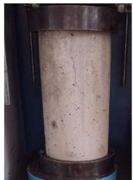
TIPO DE FALLA: 3
