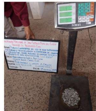
Peso proctor + muestra compactada 3: 9700 g
