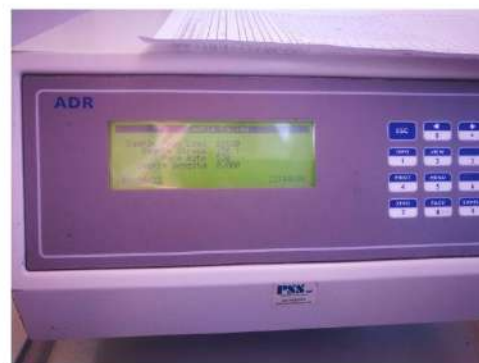
CARGA DE ROTURA: 26520 kg
