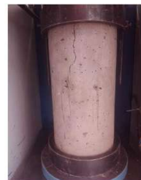
TIPO DE FALLA: 3
