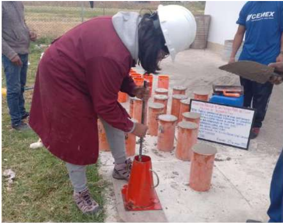
Varillado de mezcla en el cono
