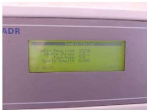
CARGA DE ROTURA: 38550 kg
