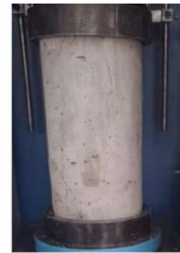
TIPO DE FALLA: 3
