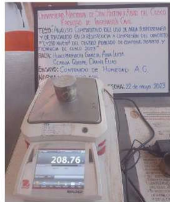
Peso de capsula 02 + agregado grueso humedo: 208.76 g
