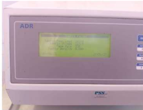
CARGA DE ROTURA: 28960 kg
