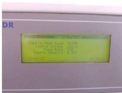
CARGA DE ROTURA: 46970 kg
