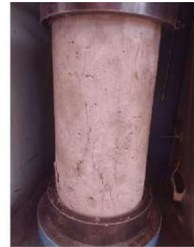
TIPO DE FALLA: 3
