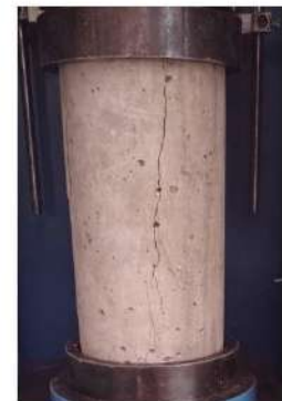
TIPO DE FALLA: 3
