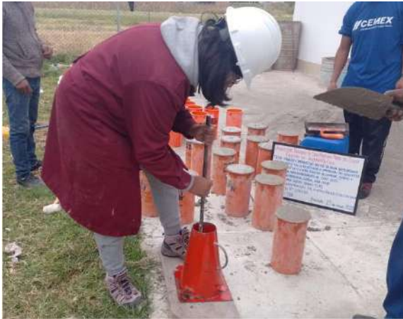
Varillado de mezcla en el cono
