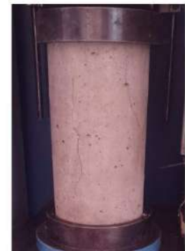
TIPO DE FALLA: 3
