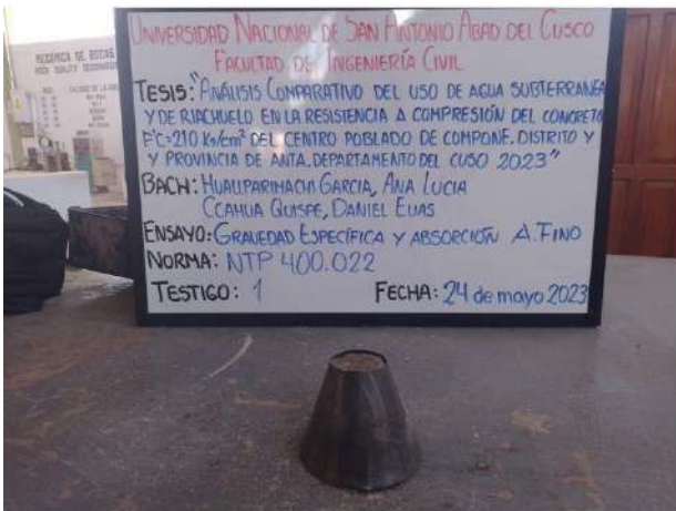
Prueba del cono para ver si esta en el estado sss
