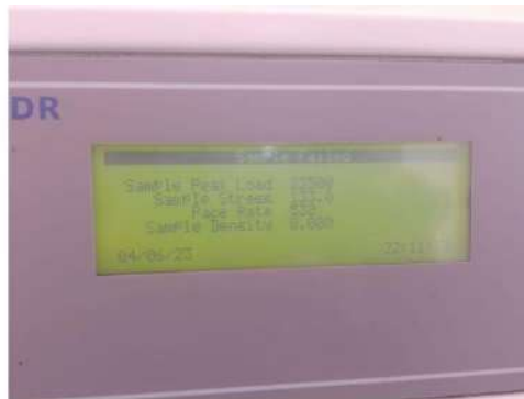
CARGA DE ROTURA: 23500 kg
