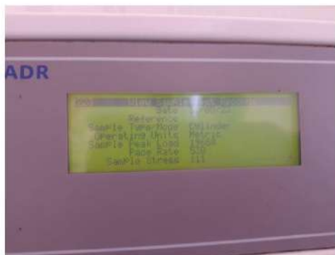
CARGA DE ROTURA: 19660 kg
