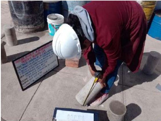
Medida de la altura de la probeta
