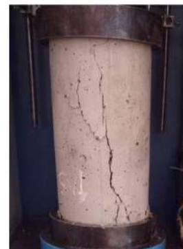
TIPO DE FALLA: 3
