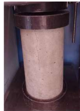
TIPO DE FALLA: 3
