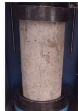
TIPO DE FALLA: 3
