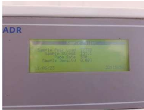
CARGA DE ROTURA: 27770 kg
