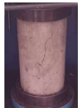
TIPO DE FALLA: 3
