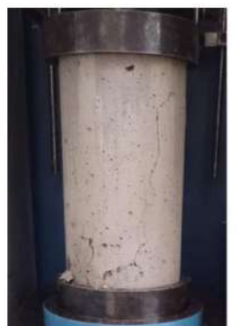
TIPO DE FALLA: 3
