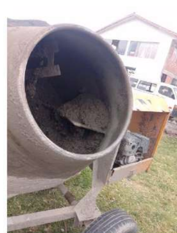
Mezclar el concreto por 3 min., descansar 3 min. y luego mezclar 2 min. mas.
