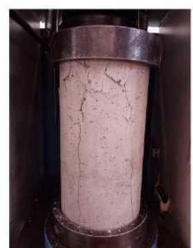
TIPO DE FALLA: 3
