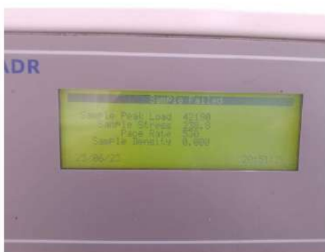
CARGA DE ROTURA: 42190 kg
