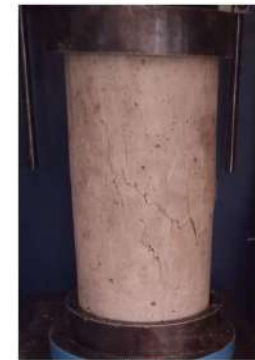
TIPO DE FALLA: 4
