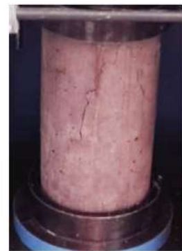
TIPO DE FALLA: 4
