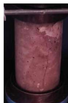
TIPO DE FALLA: 3
