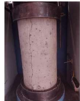
TIPO DE FALLA: 3
