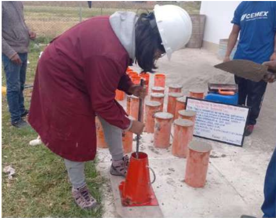
Varillado de mezcla en el cono
