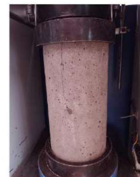
TIPO DE FALLA: 3
