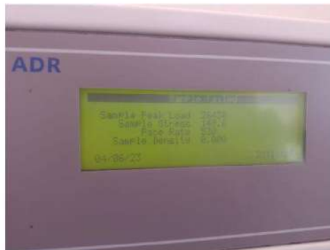
CARGA DE ROTURA: 26430 kg
