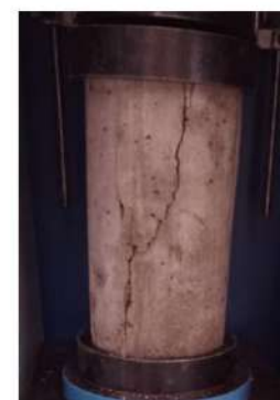
TIPO DE FALLA: 3
