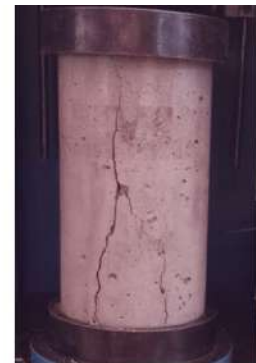
TIPO DE FALLA: 2
