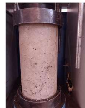
TIPO DE FALLA: 1
