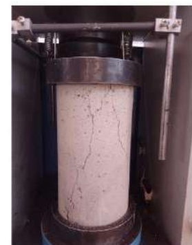
TIPO DE FALLA: 3
