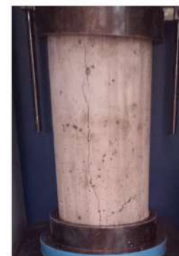
TIPO DE FALLA: 3
