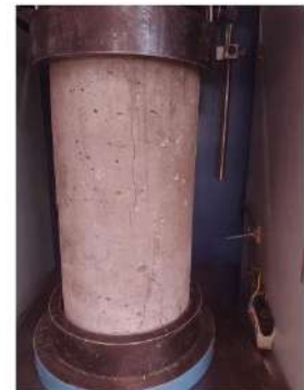
TIPO DE FALLA: 3
