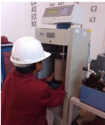
Colocacion de la probeta a la maquina
