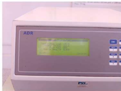
CARGA DE ROTURA: 19730 kg
