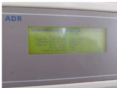
CARGA DE ROTURA: 37800 kg
