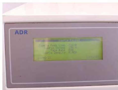
CARGA DE ROTURA: 31610 kg
