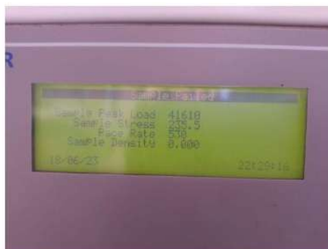
CARGA DE ROTURA: 41610 kg
