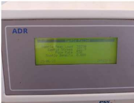
CARGA DE ROTURA: 39210 kg
