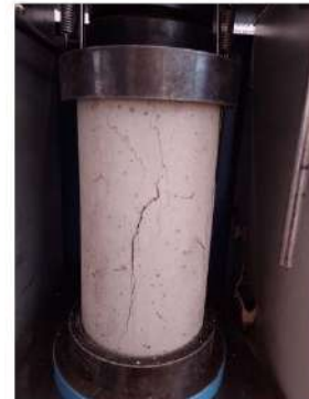
TIPO DE FALLA: 3
