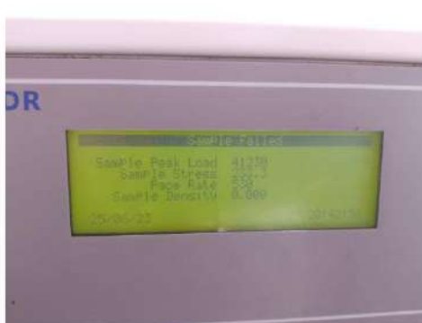
CARGA DE ROTURA: 41230 kg
