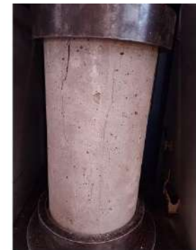
TIPO DE FALLA: 3
