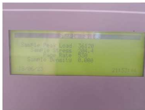
CARGA DE ROTURA: 36120 kg
