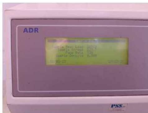
CARGA DE ROTURA: 22910 kg
