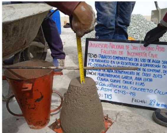
Levantar verticalmente el cono
