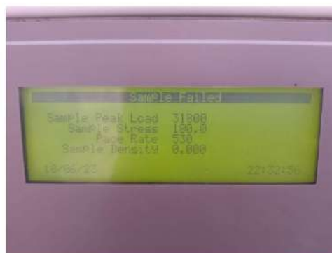
CARGA DE ROTURA: 31800 kg
