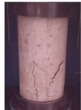
TIPO DE FALLA: 3
