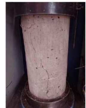
TIPO DE FALLA: 3
