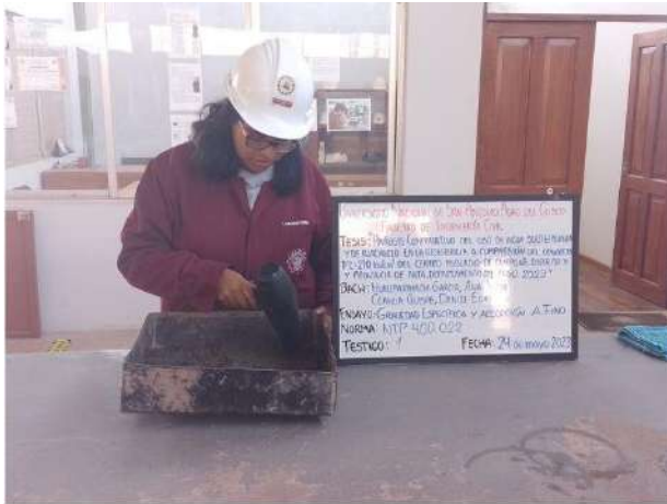
Secado superficial hasta obtener una muestra saturada superficialmente seca
