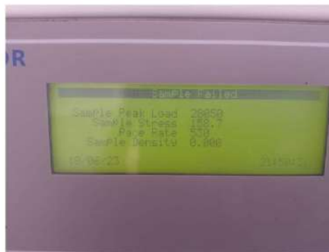
CARGA DE ROTURA: 28050 kg
