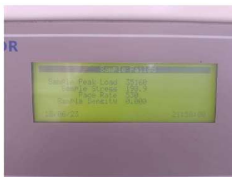
CARGA DE ROTURA: 35160 kg
