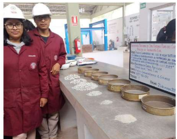
Granulometría del agregado grueso
