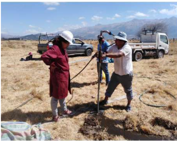
Perforado y extracción de materiales por bombeo
