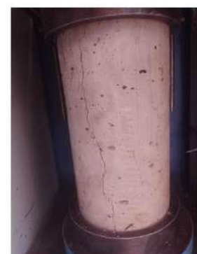
TIPO DE FALLA: 3
