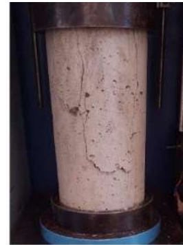
TIPO DE FALLA: 3
