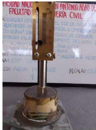
Penetración a la muestra de agua subterránea
