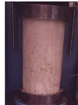
TIPO DE FALLA: 2
