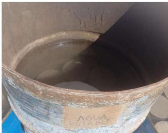
Curado de las briquetas de agua potable con agua potable
