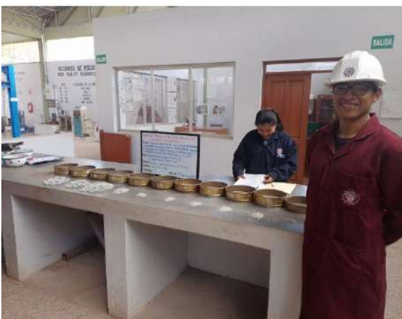
Granulometría del agregado grueso
