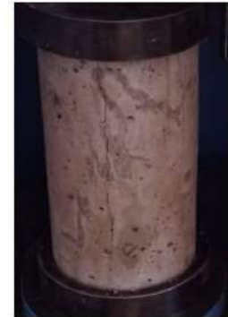
TIPO DE FALLA: 3
