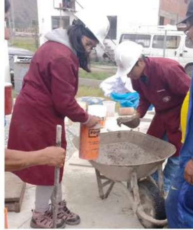
Llenado de las probetas con mezcla.
