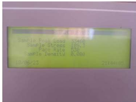
CARGA DE ROTURA: 33460 kg
