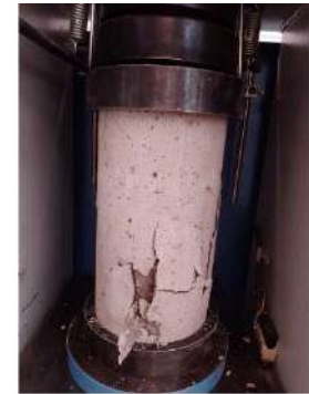
TIPO DE FALLA: 1
