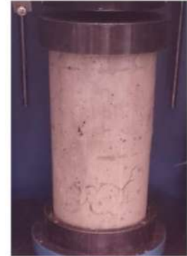
TIPO DE FALLA: 4
