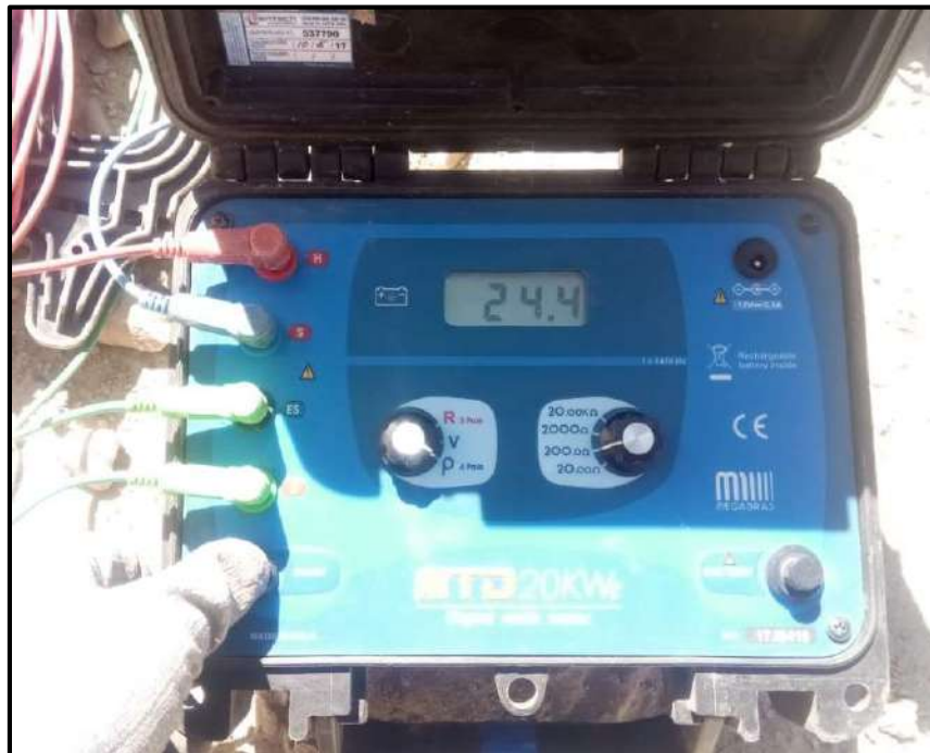
Fotografía 2. Valor obtenido de resistencia eléctrica a una distancia a=1m
