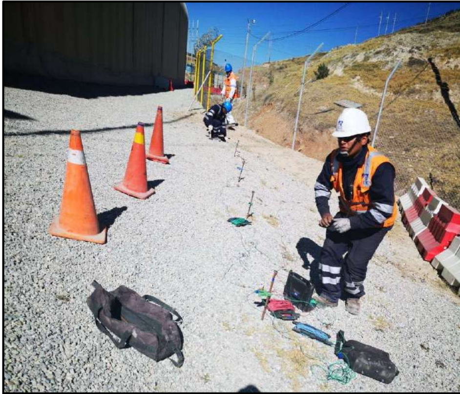
Fotografía 1. Medición de resistencia en punto “a”
