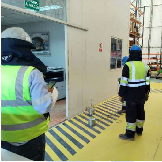
Medición de tensión de paso interiores de almacén
