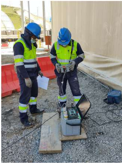
Montaje y sincronización de equipos de medición
