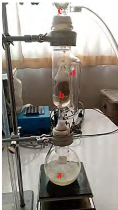
*Nota.* a: balón, b: cámara de extracción con el empaquetamiento de semillas, c: refrigerante o condensador, d: sifón o brazo para el ascenso del vapor.
