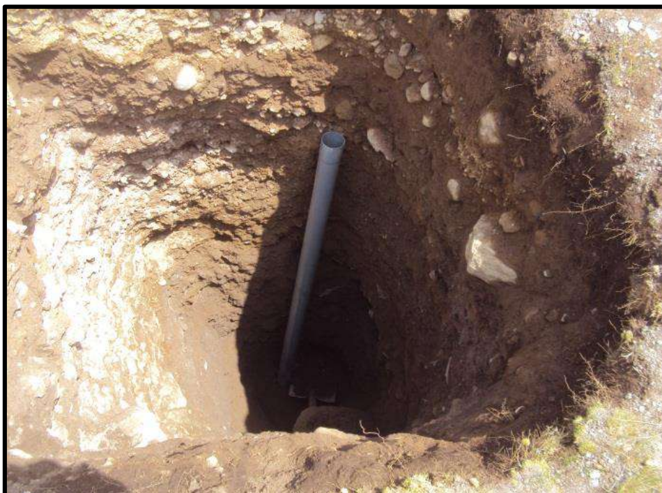
Foto 45: Ensayo de permeabilidad tipo Lefranc variable
