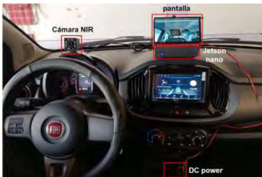
Figura 6.10: Sistema instalado en el vehículo.
