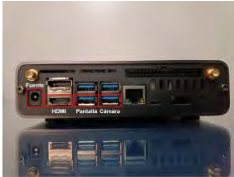
Figura 5.12: Puertos asignados del Jetson Nano.
