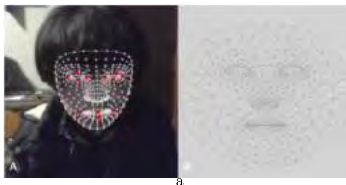
Figura 2.18: Detección de características con mediapipe face mesh.
