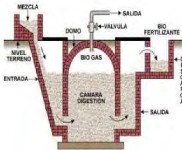
Figura 1.4: Biodigestor de domo fijo Fuente: (Sotaquira Medina et al., 2015)
