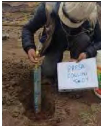
*Foto 13: Ensayo de permeabilidad K-01.*
