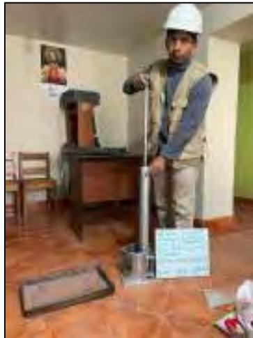
*Nota: Ensayo de Proctor modificado de la cantera.*
