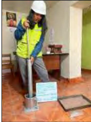
*Nota: Ensayo de Proctor modificado.*
