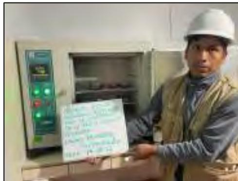
*Nota: Ensayo de humedad de las calicatas*
