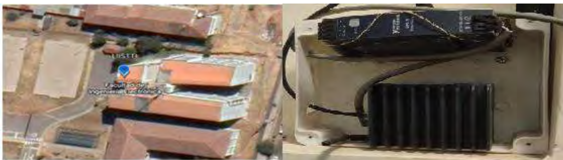
Figura 3.73 Puerta de enlace WSN NI-9792 en las instalaciones de LIISTTI.
