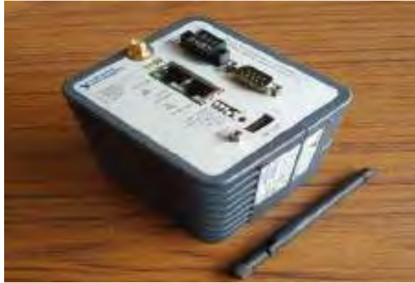
Figura 3.2 Puerta de enlace Gateway NI-9792 (Elaboración Propia)
