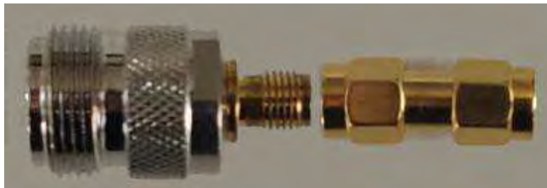
Figura 4.4 Acopladores para realizar la medición.
