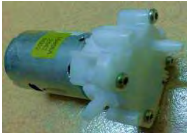
Figura 3.10 Mini bomba de agua de diafragma
