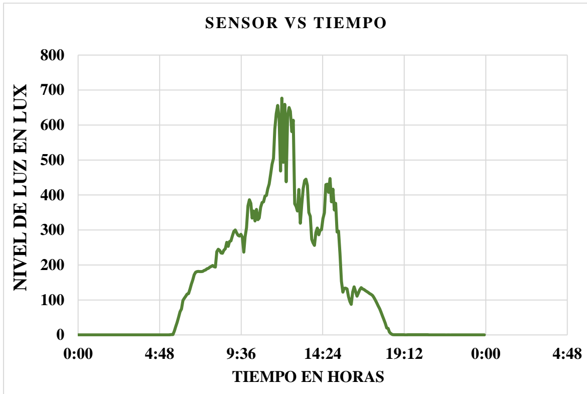
Figura 4.26 Gráfica Intensidad de Luz (sensor)
