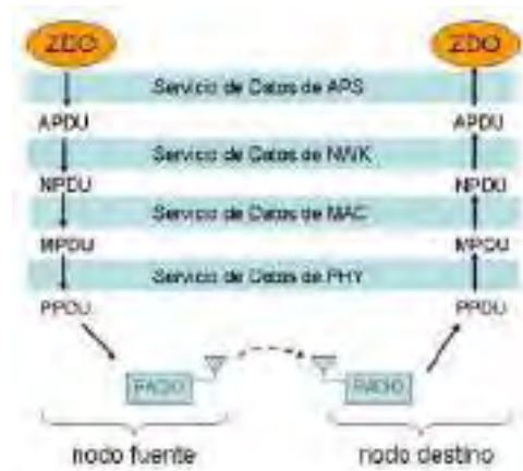
Figura 2.9 Transferencia de datos de dos dispositivos ZigBee pasando por sus capas [17].
