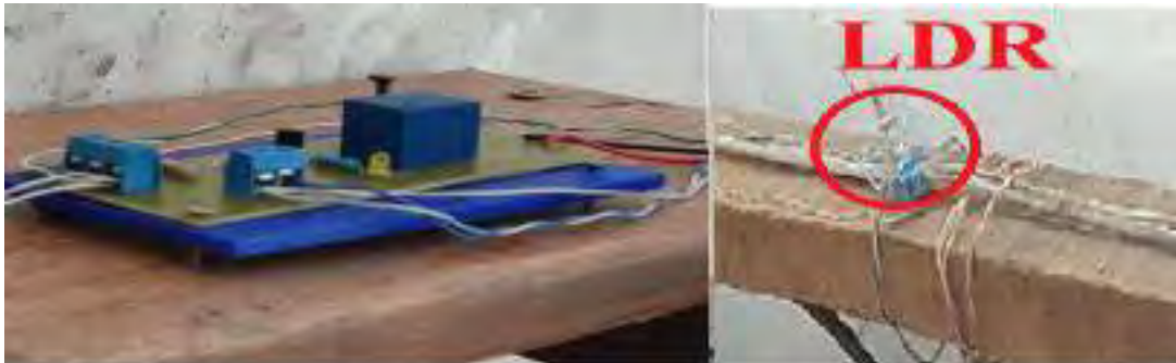
Figura 3.77 Ubicación del sensor de luz
