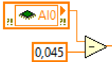
Figura 4.8 Calibración del valor medido del sensor de temperatura.
