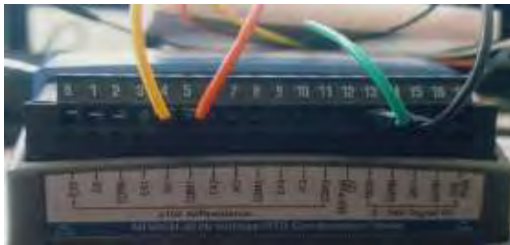
Figura 3.5 Vista de las entradas del nodo WSN NI-3226
