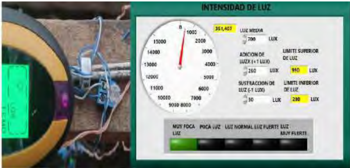
Figura 4.11 Medición de la intensidad de luz en el invernadero.
