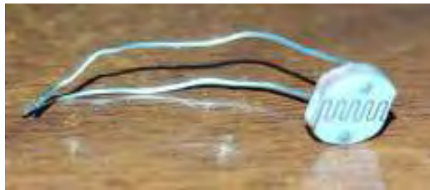
Figura 3.9 Sensor de Luz LDR
