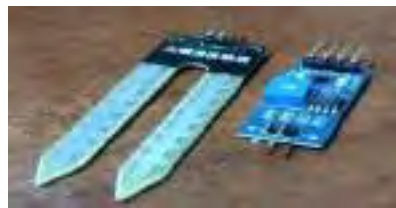
Figura 3.7 Sensor de humedad YL-69
