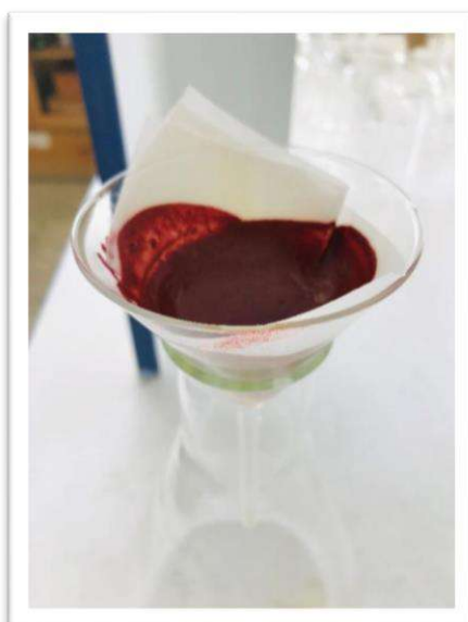
Fotografía 5: Obtención del colorante natural extraído de las semillas de Bixa orellana L. (Achiote)
