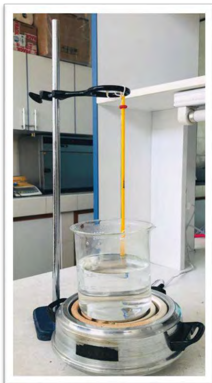
Fotografía 13: Determinación del punto de fusión de lipstick formulado en base al colorante natural extraído de las semillas de Bixa orellana L. (Achiote)
