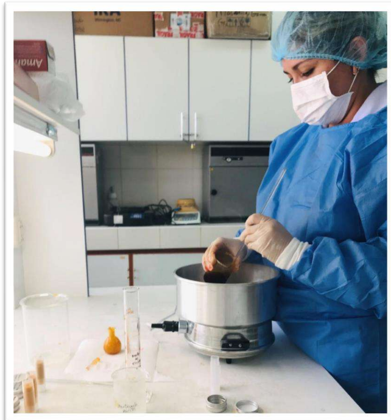
Fotografía 9: Elaboración de lipstick formulado en base al colorante natural extraído de las semillas de Bixa orellana L. (Achiote)
