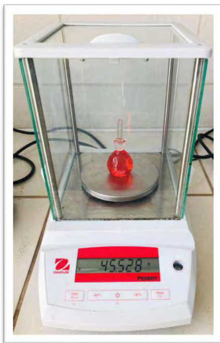
Fotografía 12: Determinación de densidad de Lipstick formulado en base al colorante natural extraído de las semillas de Bixa orellana L. (Achiote)
