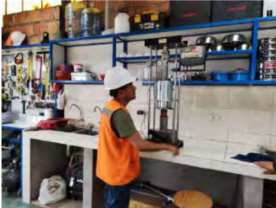
Fotografía 6-19: Proceso de CBR, lectura en la prensa
