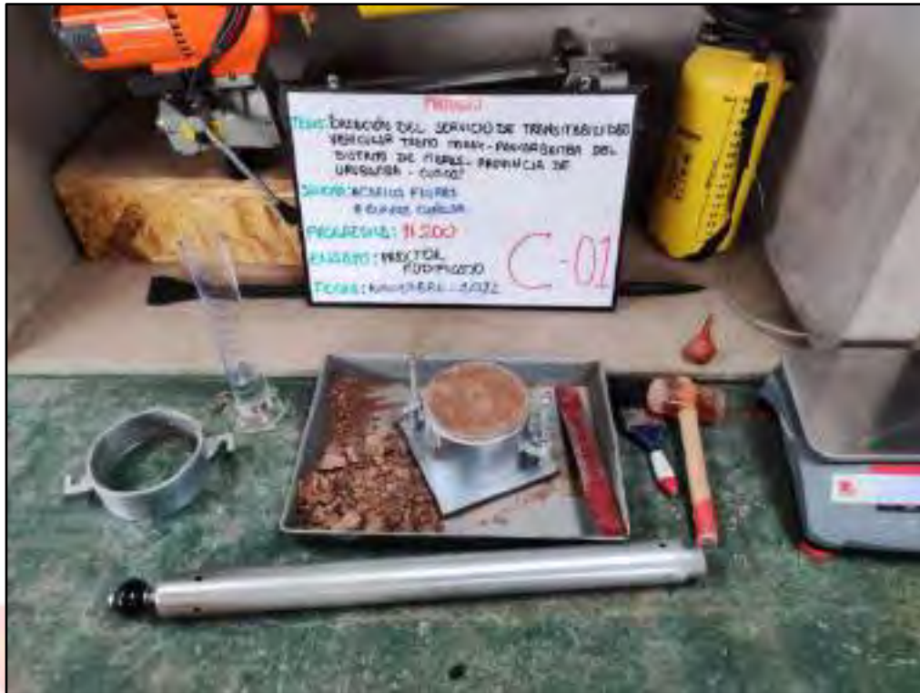
Figura 5.-Ensayo de Proctor modificado, CODIGO DE CALICATA C-01.
