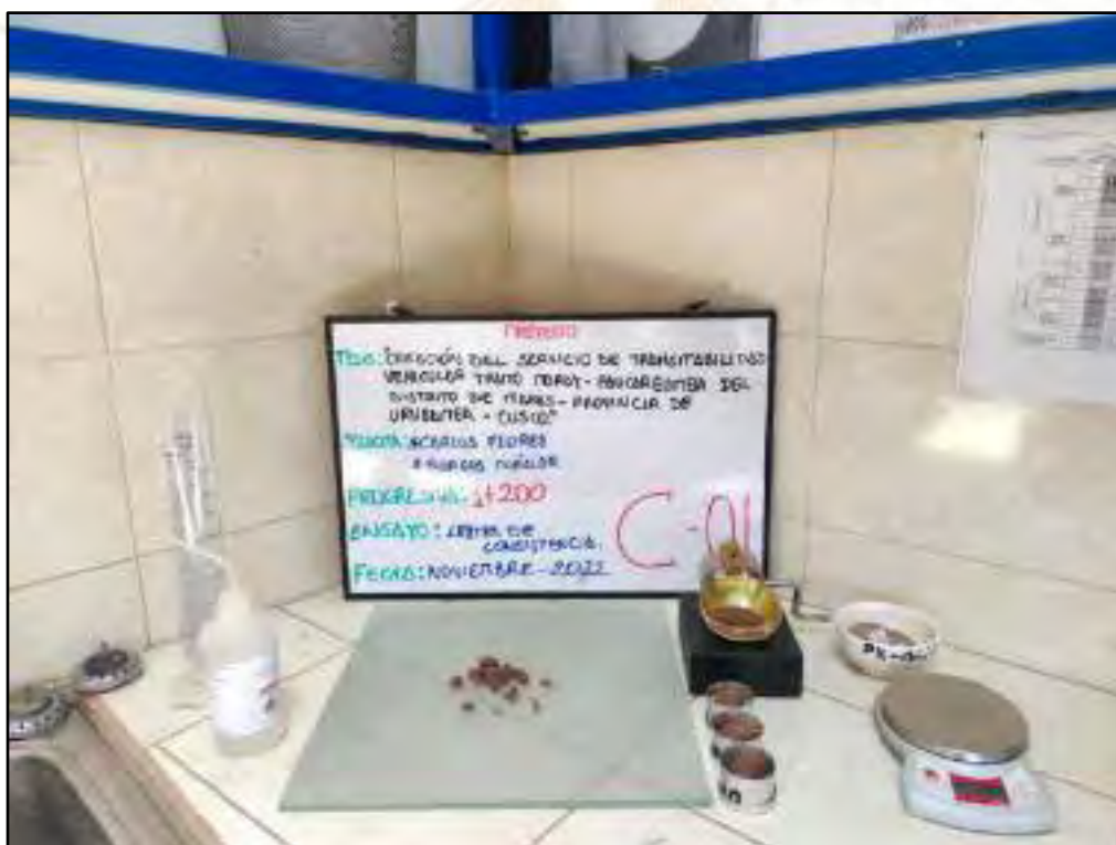
Figura 4.- Limite Liquido (izquierda) y Limite Plástico (derecha), CODIGO DE CALICATA C-01.
