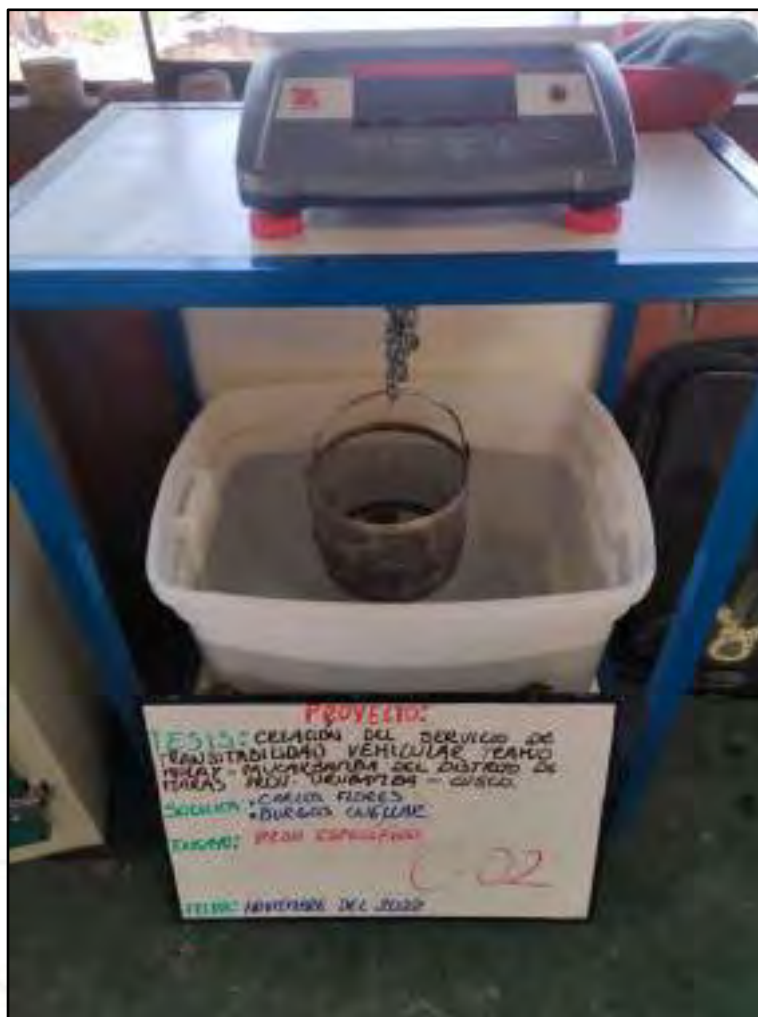
Figura 14-. Ensayo de peso específico de gravas, CODIGO DE CALICATA C-02.
