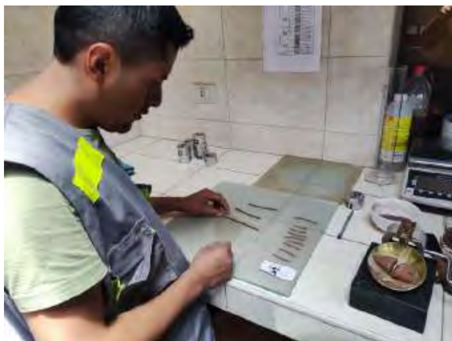
Fotografía 6-16: Proceso de limite plástico
