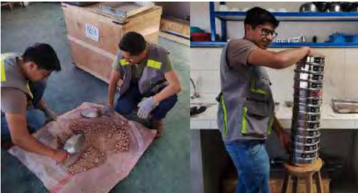
Fotografía 6-14: Proceso del ensayo de granulometría; cuarteo y tamizado
