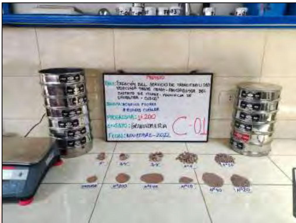
Figura 3.- Análisis granulométrico, CODIGO DE CALICATA C-01.
