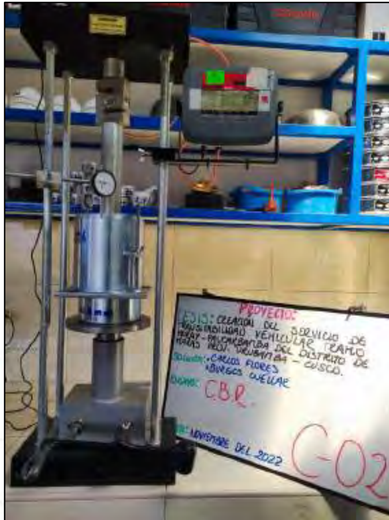
Figura 16-. Ensayo de CBR (penetración), CODIGO DE CALICATA C-02.
