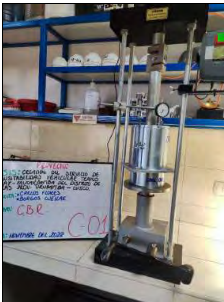
Figura 7-. Ensayo de CBR (penetración), CODIGO DE CALICATA C-01.
