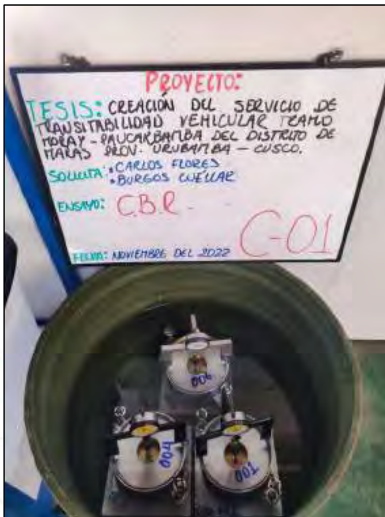
Figura 6-. Ensayo de CBR (expansión), CODIGO DE CALICATA C-01.
