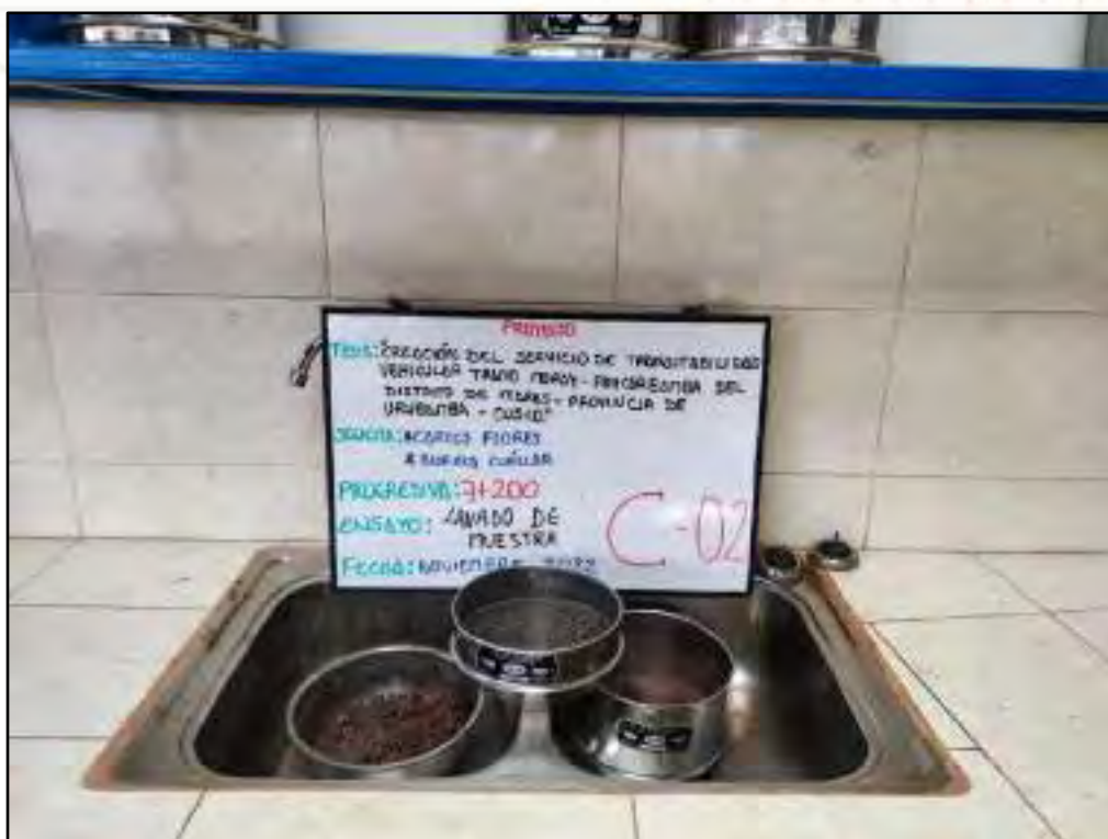
Figura 10.- Lavado del material fino que pasa del tamiz N° 200, CODIGO DE CALICATA C-02.
