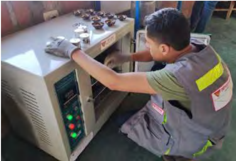
Fotografía 6-13: Secado de muestra en horno eléctrico.
