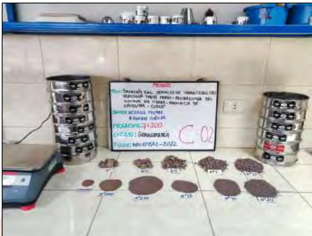
Figura 11.- Análisis granulométrico, CODIGO DE CALICATA C-02.
