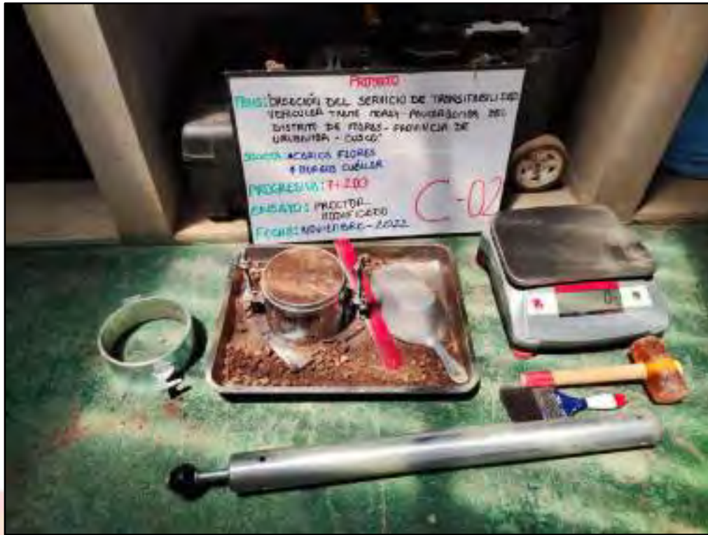
Figura 13.- Ensayo de Proctor modificado, CODIGO DE CALICATA C-02.
