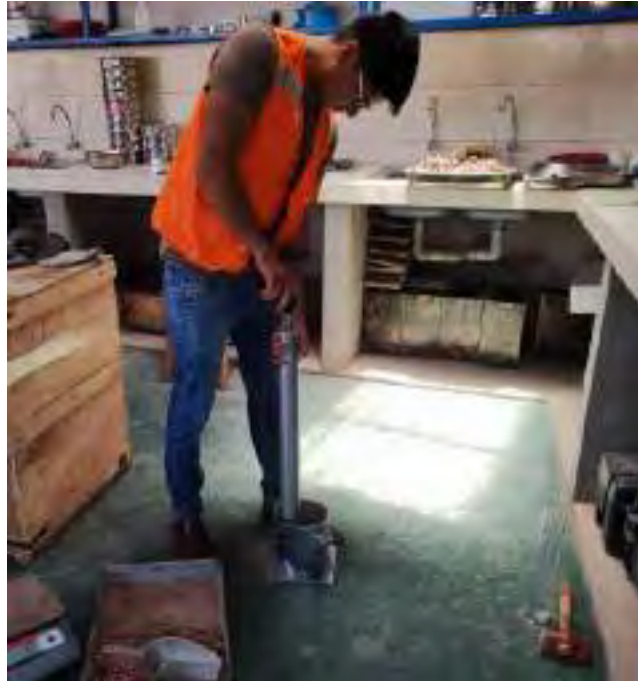
Fotografía 6-17: Proceso de Proctor modificado; pasante de la malla \frac{3}{4} con 56 golpes, cuatro moldes con diferentes cantidades de humedad para llegar a la humedad óptima.
