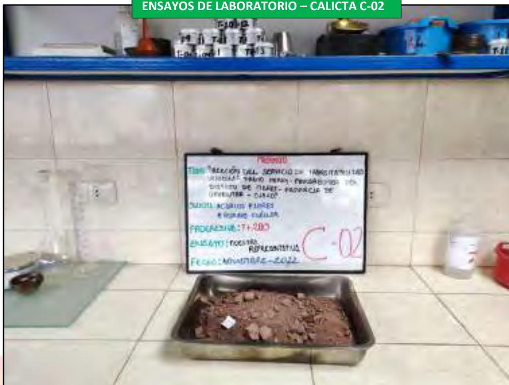
Figura 9.- Toma de muestra representativa, CODIGO DE CALICATA C-02.
