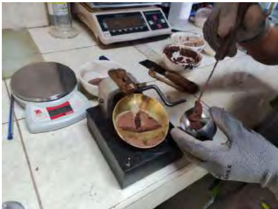
Fotografía 6-15: Proceso de limite liquido con muestra pasante de la malla N°40
