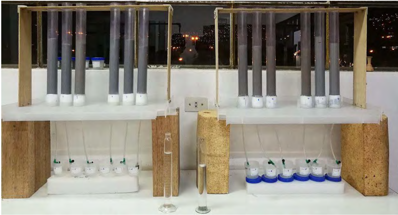
Anexo 9: Simulación del proceso de lixiviación.
