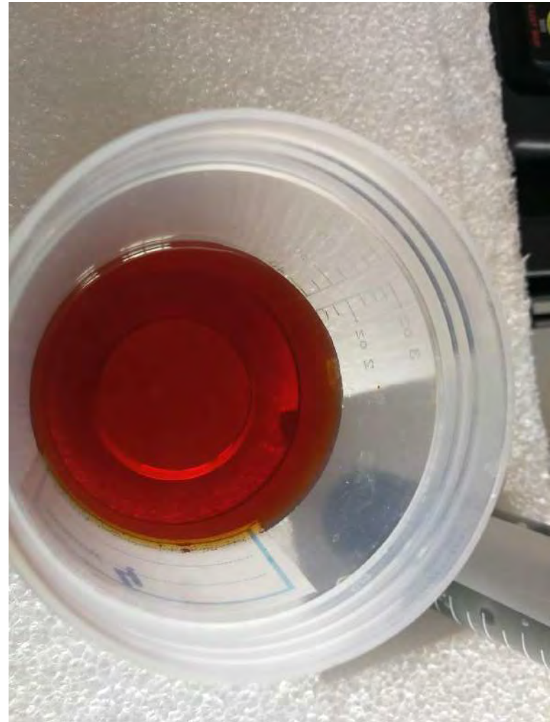
Anexo 10: Los lixiviados obtenidos a partir de las columnas de lixiviación.
