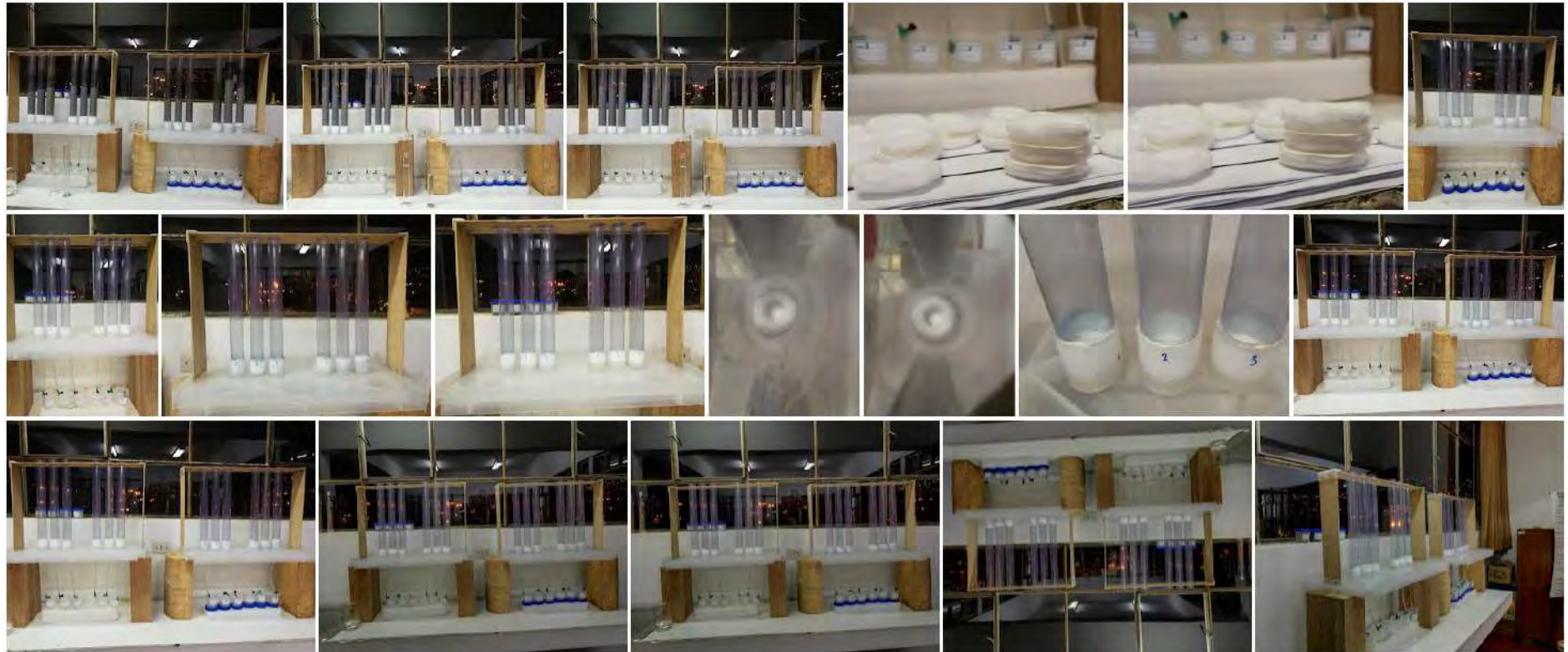
Anexo 8: Construcción de las columnas de lixiviación.
