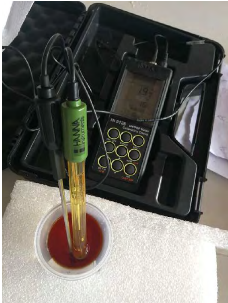
Anexo 10: Los lixiviados obtenidos a partir de las columnas de lixiviación.
