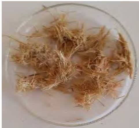
b9. Fibra lavada después de blanqueamiento
