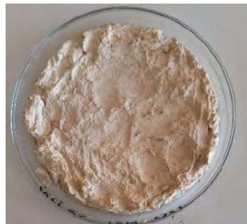
b10. Muestra 1.5 M NaOH, con blanqueamiento y tratamiento con ácido oxálico al 8%
