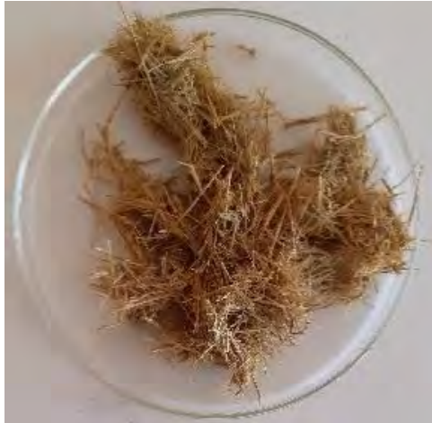
b7. Fibra con tratamiento a presión NaOH2%, lavado
