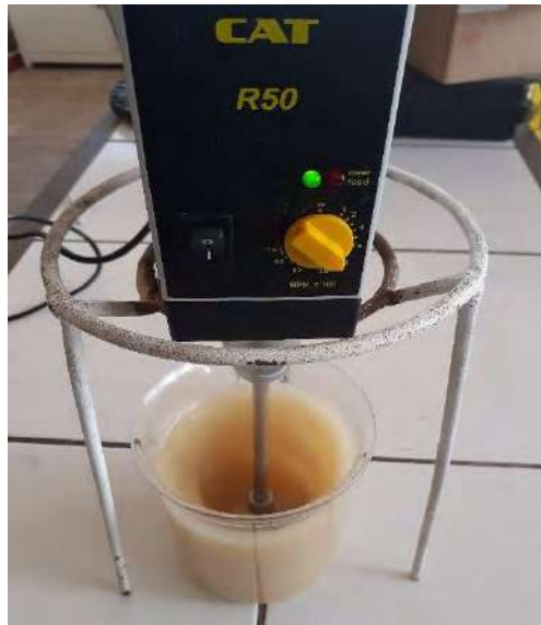
Figura 13. Agitador mecánico tipo Stirrer CATR50
