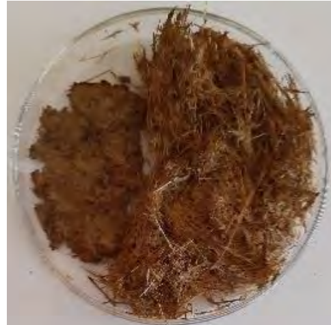
b8. Fibra con tratamiento a presión NaOH2%, sin lavar
