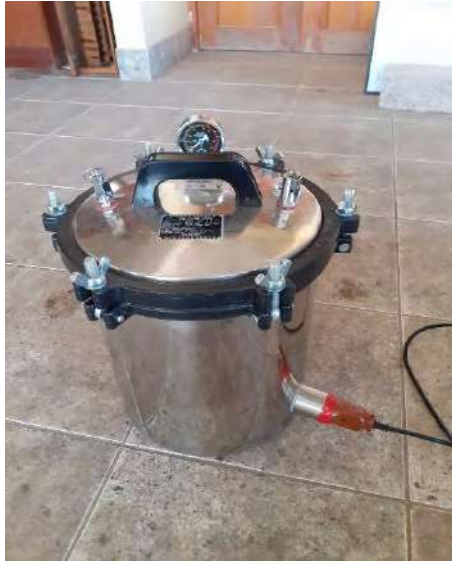
Figura 12. Equipo de explosión de vapor
