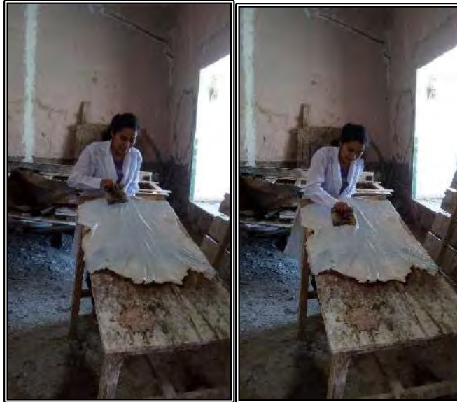
Fotografía 15. Proceso del descarnado de la piel, colocando la piel sobre el caballete, sacando la hipodermis con ayuda de la rancheta.
