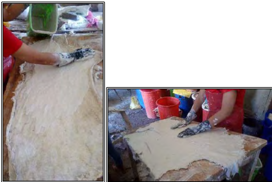
Fotografía 10. Pasada de la pasta de cal a la parte carne de las pieles.
