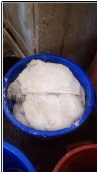
Fotografía 14. Tachos con el encalado de las pieles.
