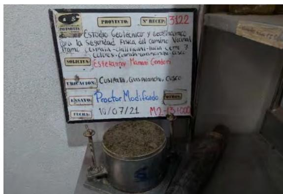
**Foto 8. 4.** Ensayo de Compactación Proctor Modificado
