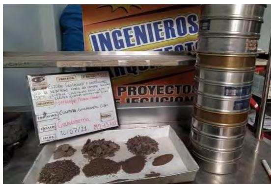
**Foto 8. 1.** Ensayo para el análisis granulométrico
