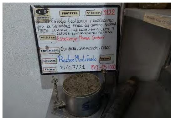
**Foto 8. 3.** Ensayo de CBR
