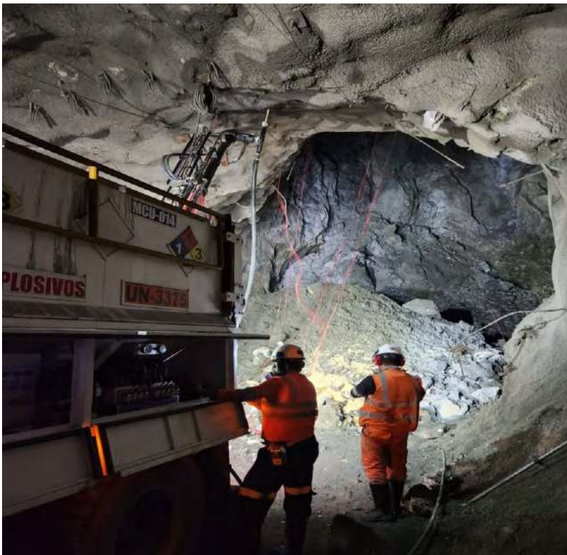
Fotografía N° 9 Carguío de Explosivos en Tajeo Kimberly
