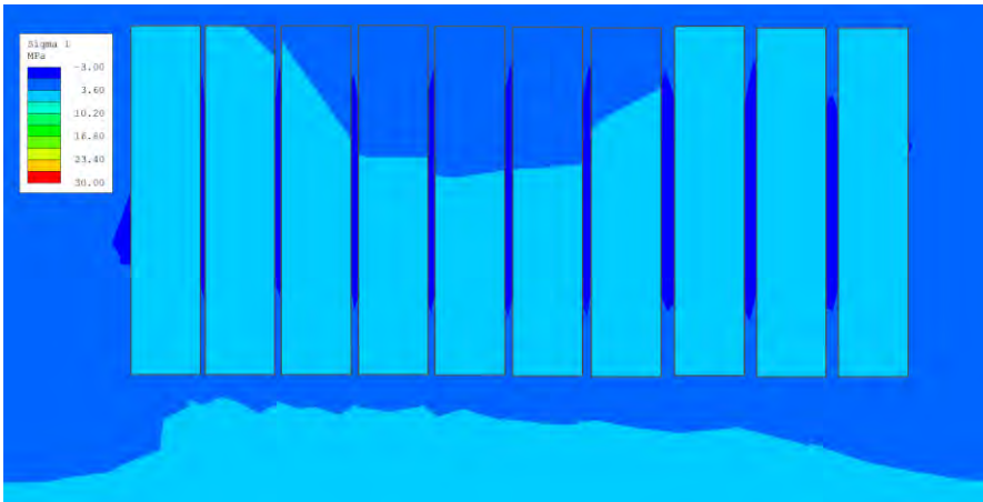
Figura N° 32 Modelamiento estabilidad Tajeo Kimberly con paneles rellenados
