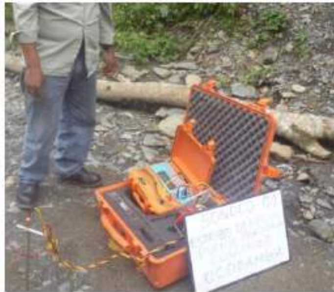
Fotografía N° 16: S.E.V. en el estribo izquierdo.
