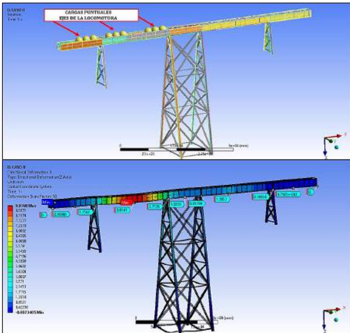
Figura 5. 15 Deformación de la estructura del puente ferroviario Sumbay sometida a carga estática CASO N°2. (Fuente: Ansys Workbench.)
