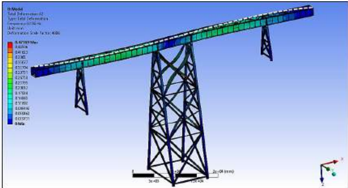
Figura 5. 40 Modo a 8.14 Hz. (Fuente: Ansys Workbench.)
