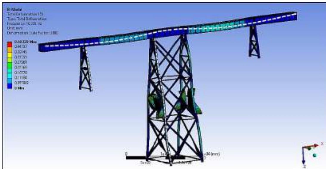
Figura 5. 44 Modo a 16.34 Hz. (Fuente: Ansys Workbench.)
