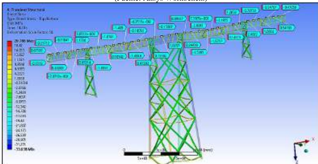
Figura 5. 35 Esfuerzos en arriostres de estructura de viga principal de puente ferroviario. (Fuente: Ansys Workbench.)
