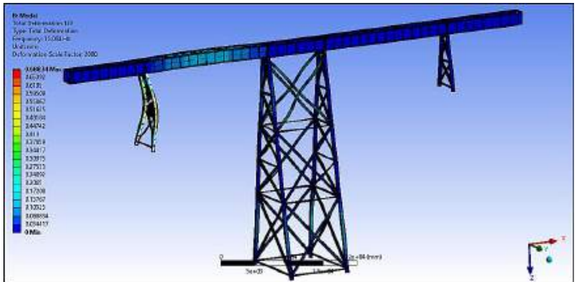
Figura 5. 43 Modo a 15.06 Hz. (Fuente: Ansys Workbench.)
