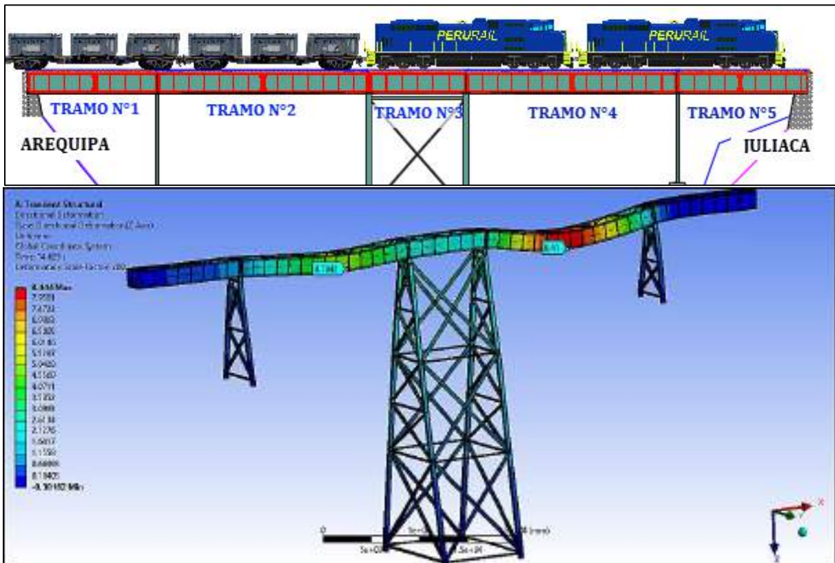
Figura 5. 31 Deformación de la estructura del puente ferroviario Sumbay sometida a carga dinámica CASO N°4. (Fuente: Elaboración Propia)
