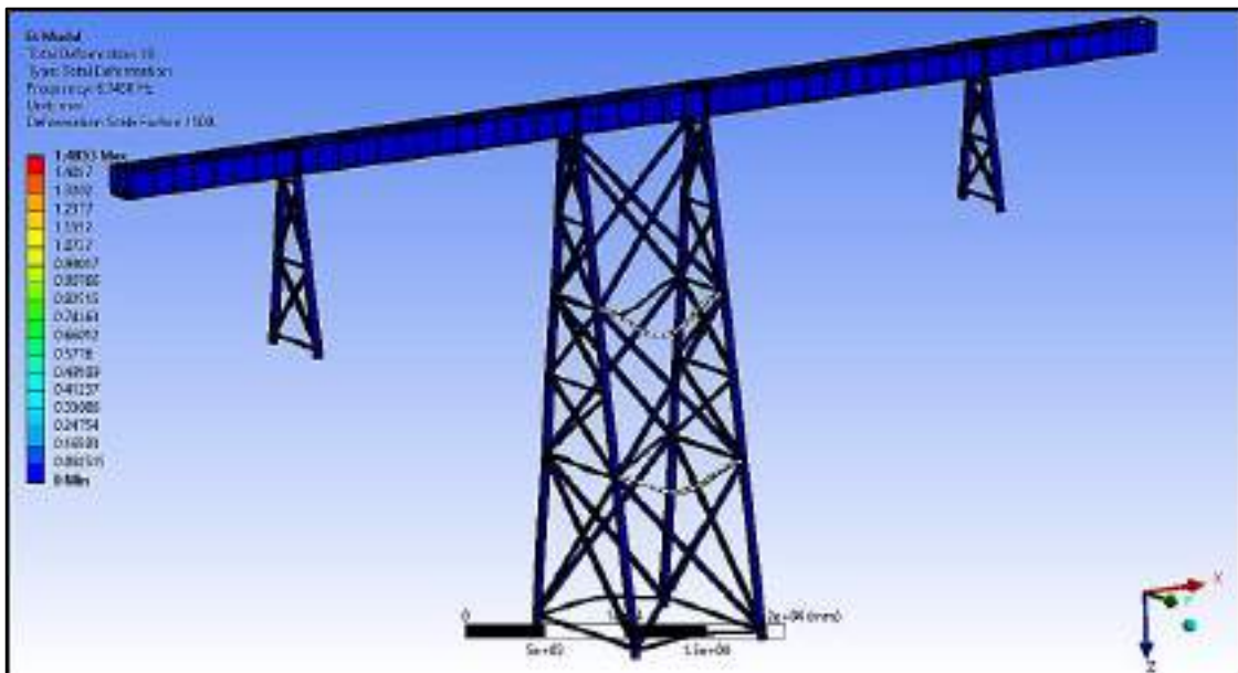
Figura 5. 39 Modo a 6.75 Hz (Fuente: Ansys Workbench.)
