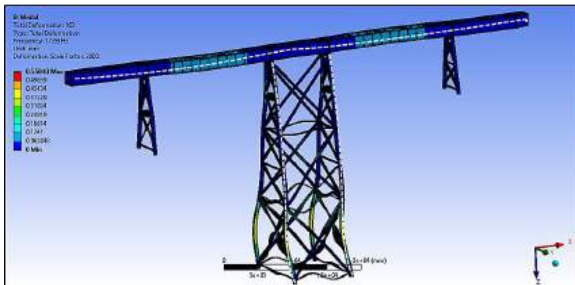
Figura 5. 45 Modo a 17.68 Hz (Fuente: Ansys Workbench.)
