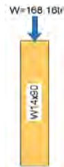
Figura 8-1. Carga vertical en la columna B5 primer nivel. Fuente: Elaborado por los autores.
