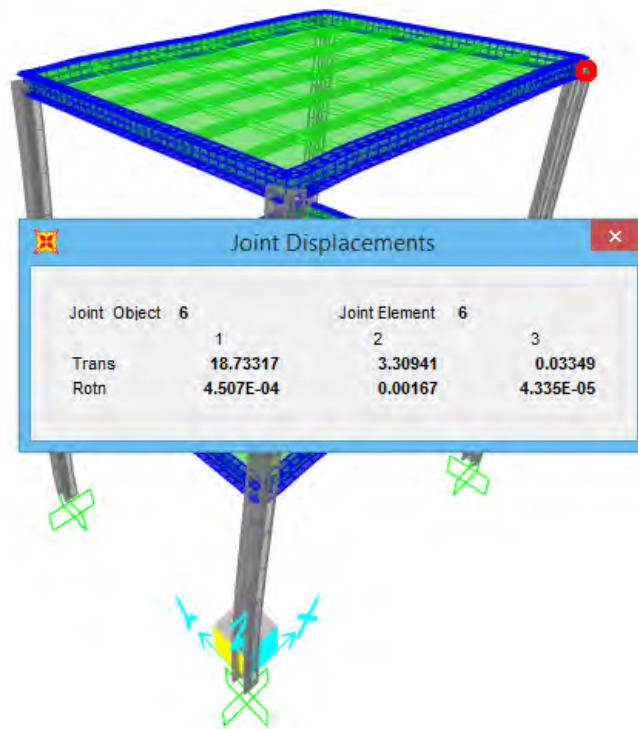
Figura 7-27. Desplazamientos laterales de nudos superiores. Fuente: SAP2000.
