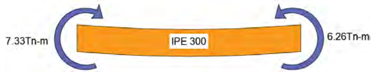
Figura 8-5. Momento resultante que actúa sobre el perfil IPE 300, en la viga B-E primer nivel eje 5. Fuente: Elaborado por los autores.
