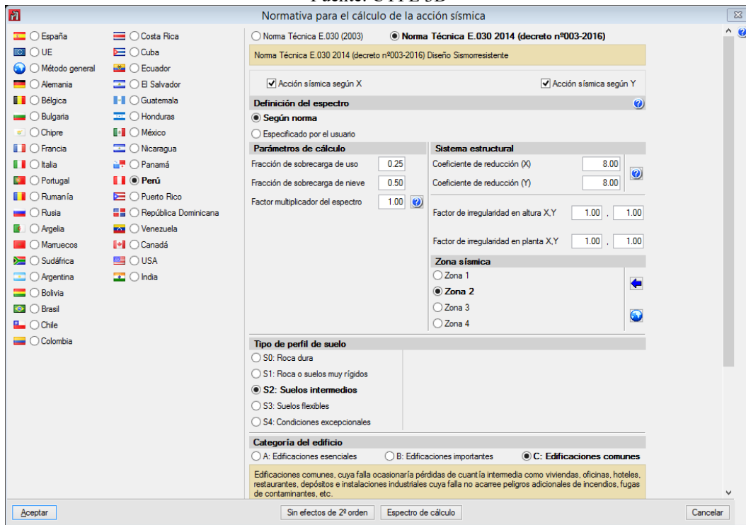
Figura 3-30. Seguidamente se procede a definir el parámetro sísmico para el espectro de cálculo Fuente: CYPE 3D
