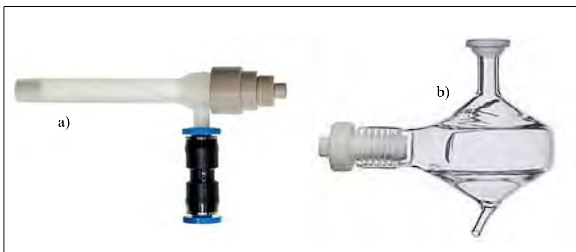
Figura 13. a) Nebulizador OneNeb Series; b) Cámara nebulizadora “spray chamber”
