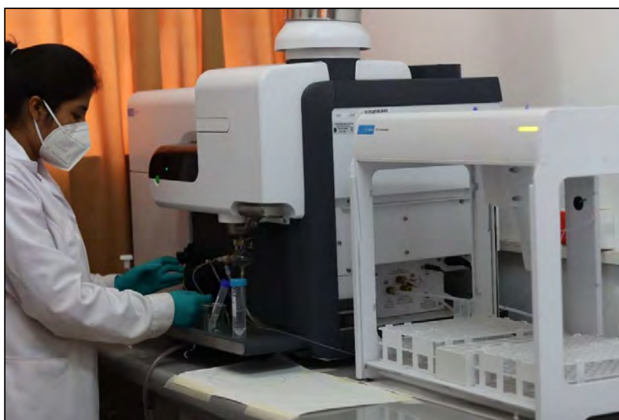
Figura 12. Espectrómetro de emisión atómica por plasma de microondas
