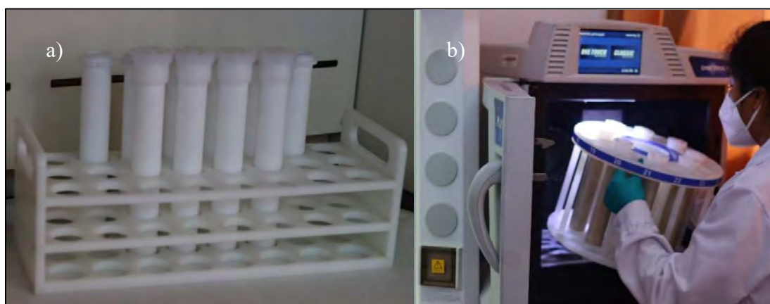
Figura 10. a) Vasos para digestión por microondas; b) Digestor Mars 6
