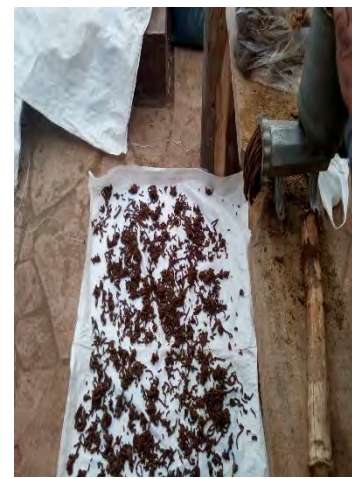
Pelletizado manual de las dietas obtenidas
