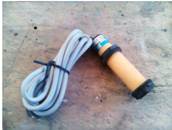
Figura 81. Transmisor de presencia infrarrojo usado para medir la velocidad de rotación de las turbinas. Fuente: Elaboración propia.
