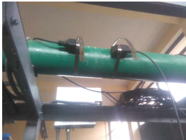
Figura 79. Montaje de los sensores ultrasónicos de caudal. Fuente: elaboración propia.
