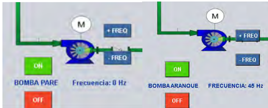
Figura 7. Encendido y variación de la velocidad de giro de la bomba principal.
