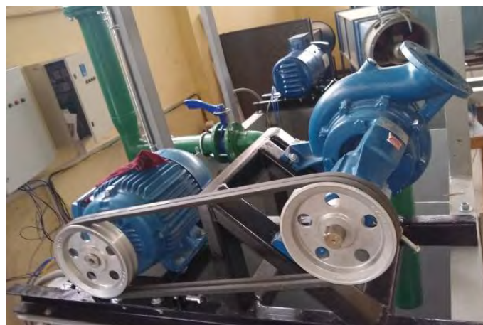
Figura 37. Grupo hidroeléctrico no convencional. Fuente: Elaboración propia.
