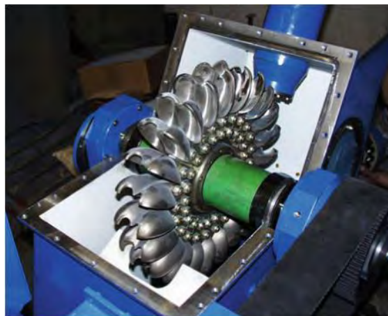
Figura 18. Turbina Pelton. Fuente: www.ricklyhydro.com citado de Carravetta, Derakhshan Houreh, & Ramos (2018)
