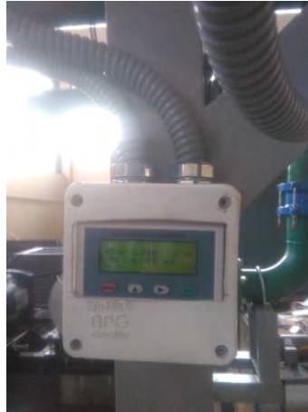
Figura 80. Display de caudal montado en el banco de pruebas. Fuente: Elaboración propia.
