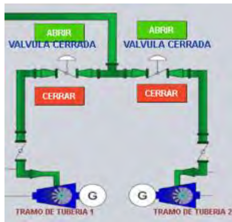
Figura 121. Apertura o cierre de electroválvulas. Fuente: Elaboración propia.
