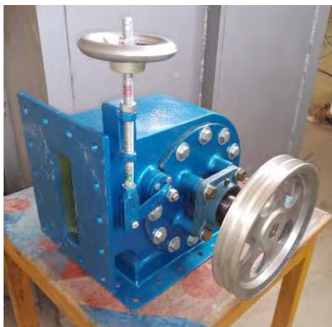
Figura 35. Turbina Michell-Banki antes de ser montada al banco de pruebas. Fuente: Elaboración propia.
