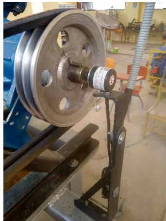
Figura 84. Encoder de velocidad en la bomba funcionando como turbina. Fuente: Elaboración propia
