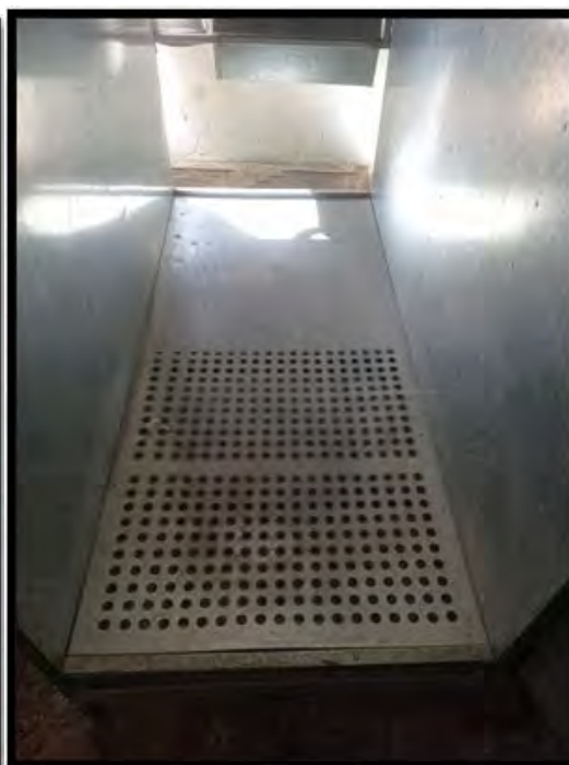
Plataforma principal de la jaula metabólica
