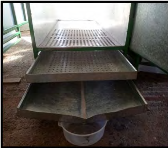
Sistema colector de heces y orina
