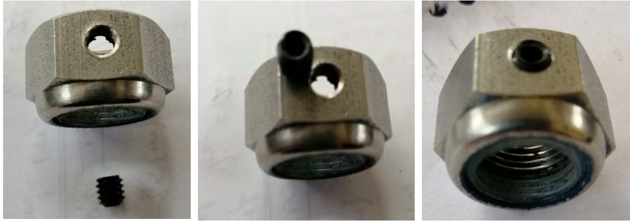
Figura 60: Adaptando el prisionero al Tornillo del impulsor. Fuente: Elaboración Propia.
