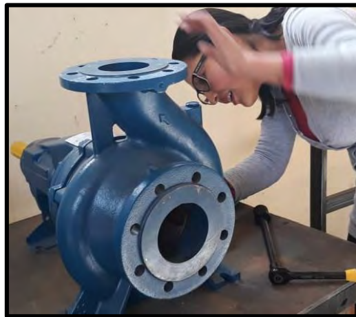
Figura 36: Desmontando los pernos de la carcasa. Fuente: Elaboración Propia.
