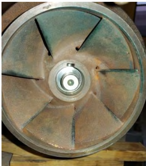
Figura 68: Comprimiendo el sello mecánico, chaveta colocada y seguidamente el rodete. Fuente: Elaboración Propia.
