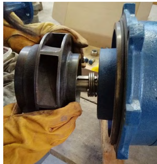
Figura 68: Comprimiendo el sello mecánico, chaveta colocada y seguidamente el rodete. Fuente: Elaboración Propia.
