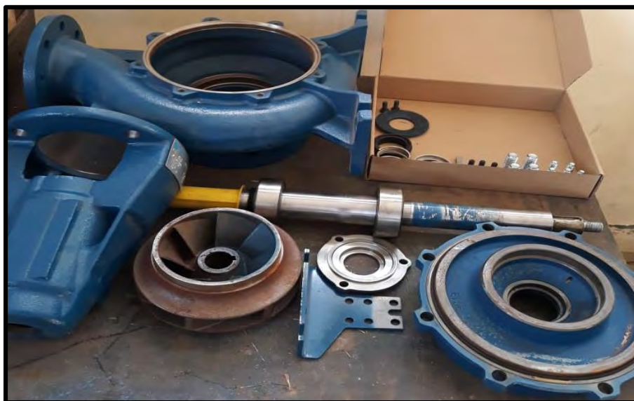
Figura 40: Bomba centrífuga desmontada. Fuente: Elaboración Propia.
