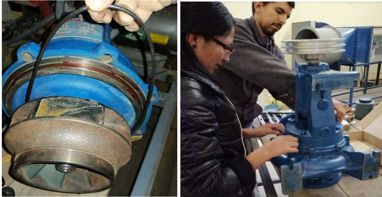
Figura 71: Colocando grasa al canal del anillo y asegurando los pernos a la carcasa. Fuente: Elaboración Propia.
