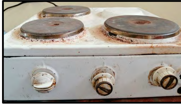
Figura 48: Carga eléctrica de 4000 W (carga resistiva con puntos variables). Fuente: Elaboración propia.
