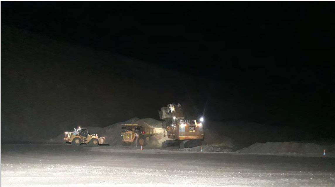
*Imagen 27 Cargador Frontal 966L Realizando limpieza en piso de pala – Shougang Hierro Perú*
