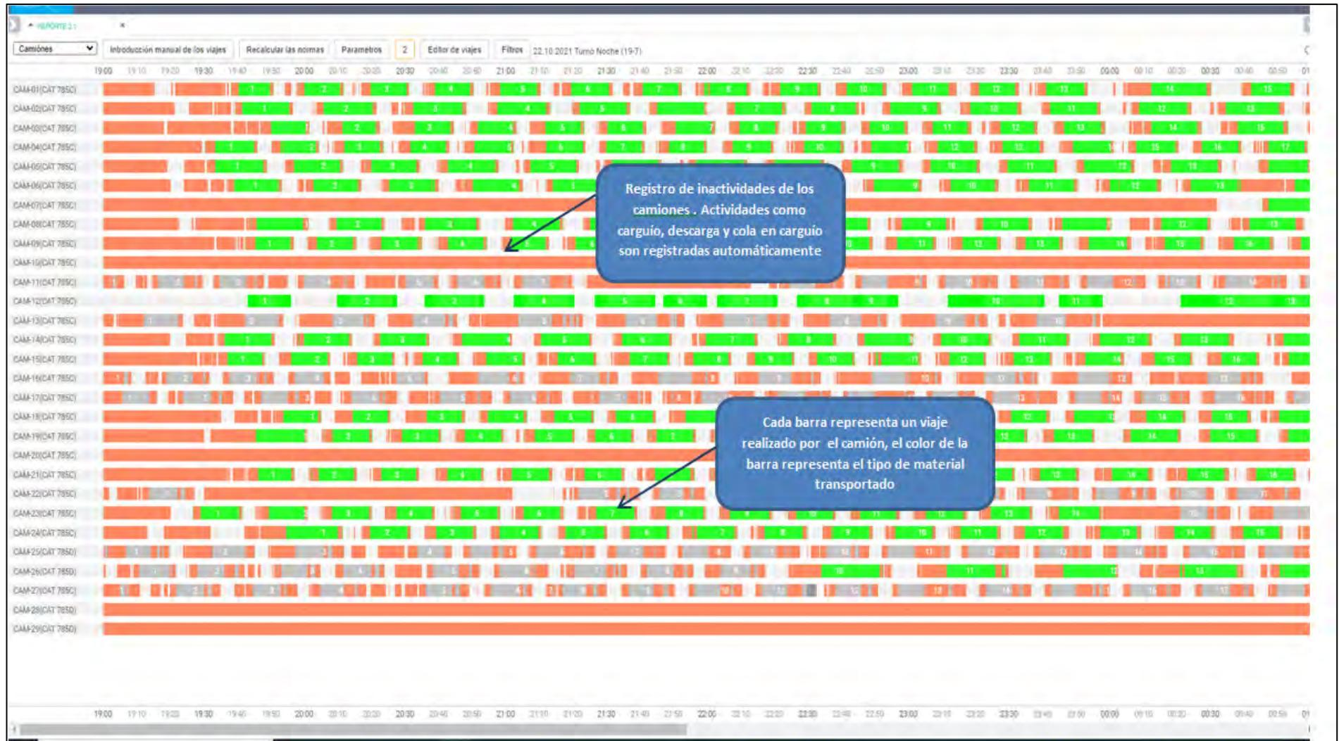
Imagen 42 Módulo de control de producción de los camiones
