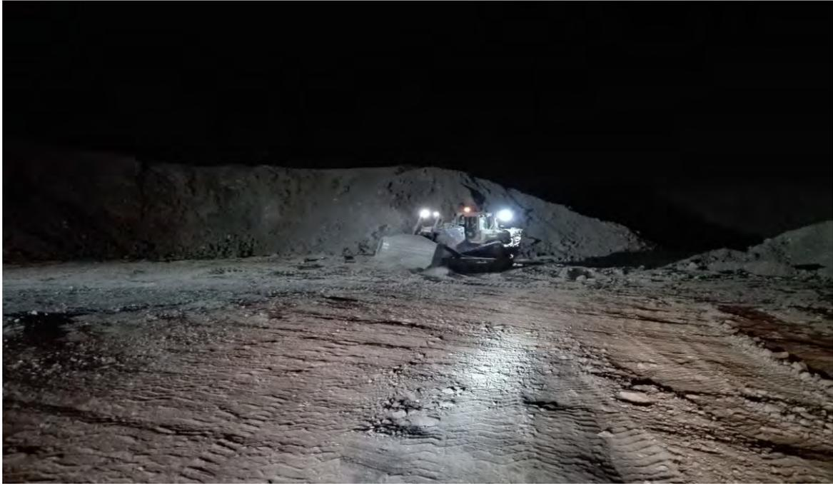
*Imagen 28 Tractor de ruedas D9T realizando empuje de material en botadero – Shougang Hierro Perú*
