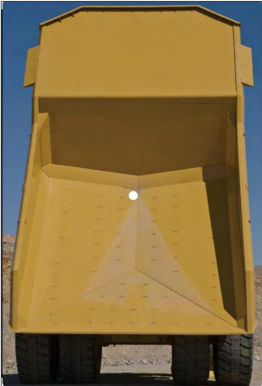
*Imagen 26 Diseño de tolva Camión Minero 785C – Shougang Hierro Perú*
