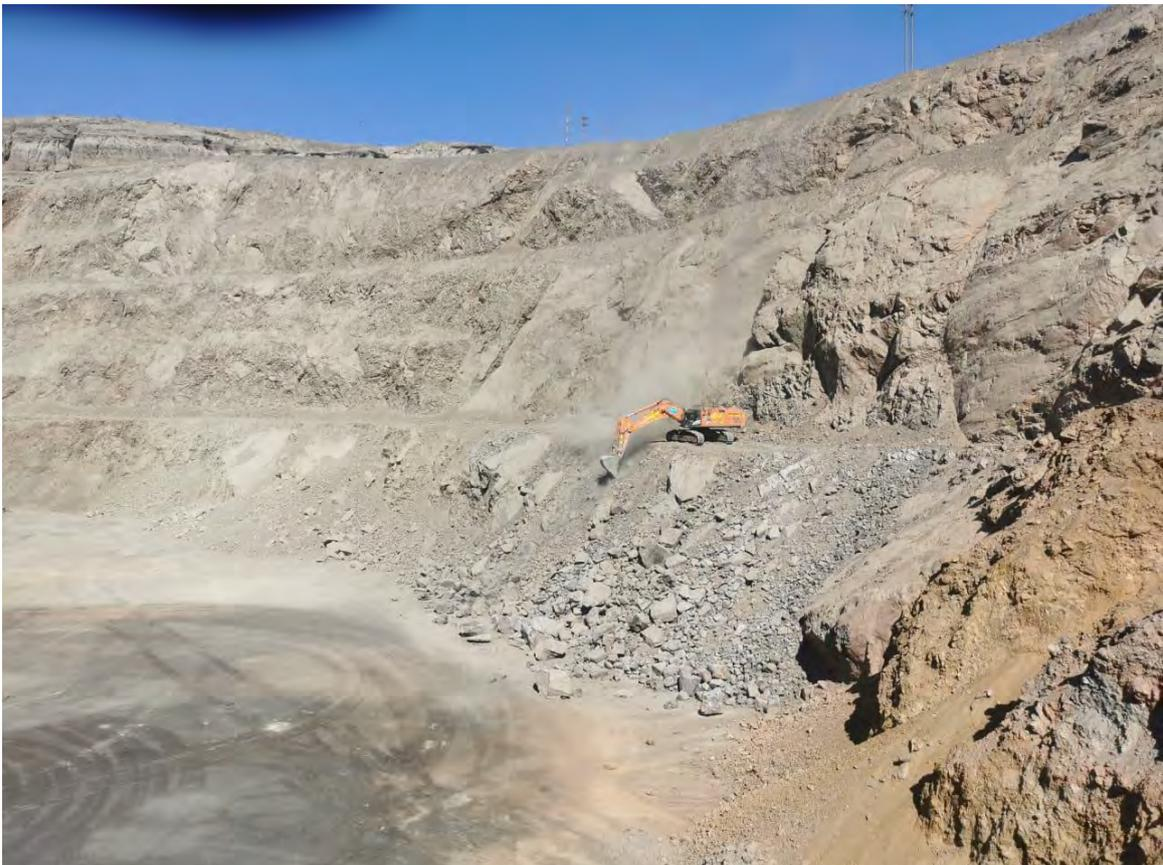
*Imagen 29 Excavadora Hitachi 850LC realizando perfilado de talud – Shougang Hierro Perú*
