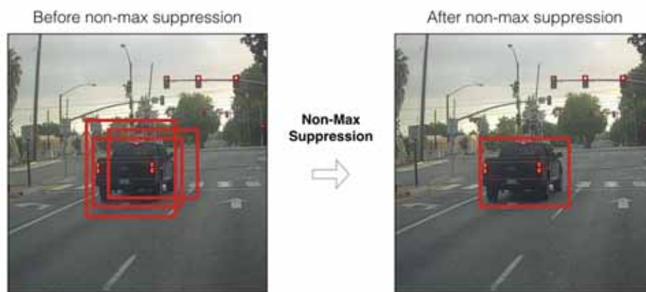
Figura 2.32: Algoritmo de Non-Maximum Suppression Fuente: K (2019)
