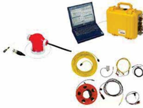
Figura N°28: Equipo de medición para ensayos de Refracción Sísmica.
