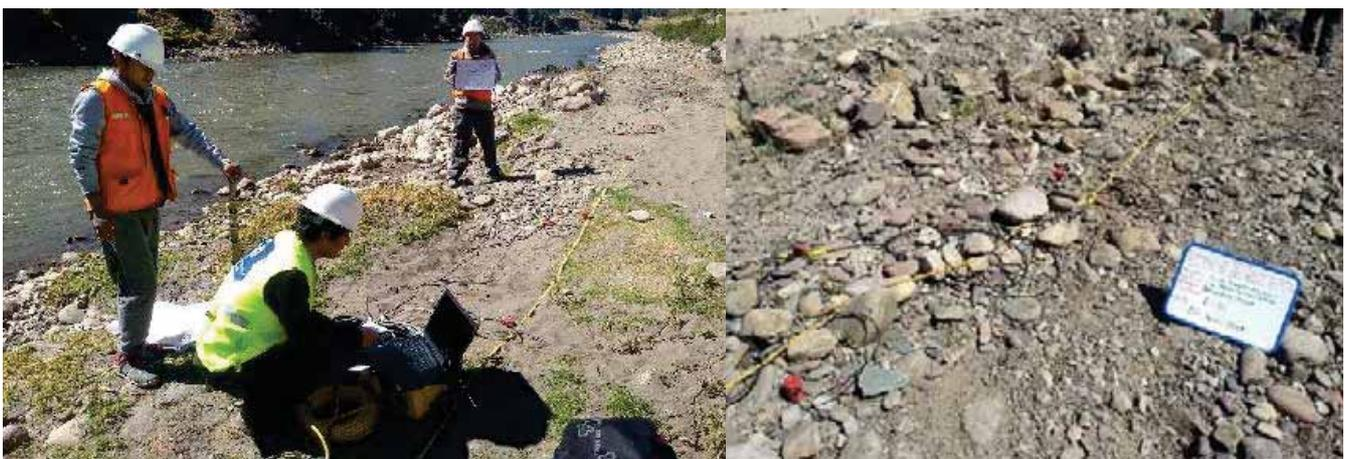
Fotografía N°13: Tendido de líneas sísmica y registro de datos.
