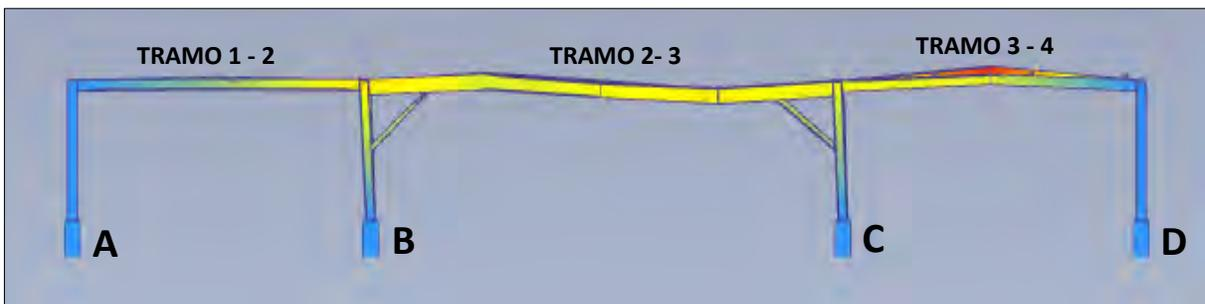
*Figura 141. Octavo Modo de 10.45 Hz (Vista Perfil).*
