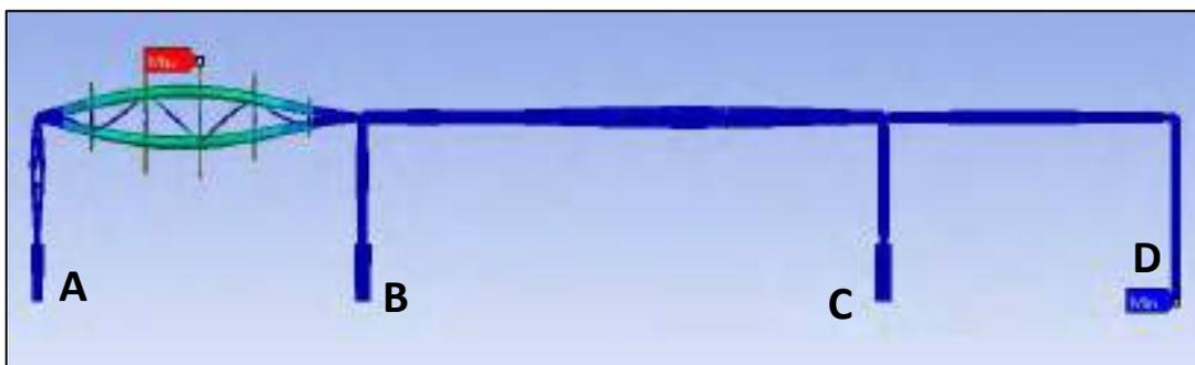
*Figura 93. Tercer Modo de vibración a 4.8 Hz (Vista de perfil).*
