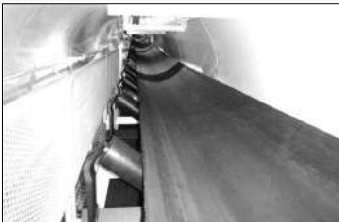
*Figura 6 Desalineamiento de faja transportadora.*
