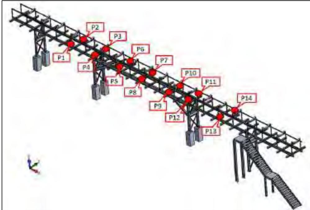
Figura 114. Puntos de medición en ensamblaje de SolidWorks del tramo 1 al 4.
