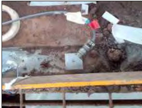
*Figura 118. Instalación de sensor triaxial en campo.*
