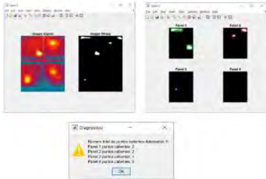
Figura 3-31. Paneles con puntos calientes a una irradiancia solar de 350 W/m 2 .
