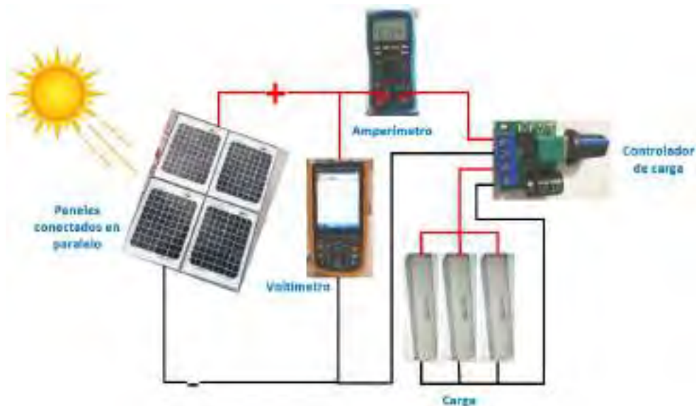
Figura 4-1. Esquema general del circuito para la obtención de la curva I-V.
