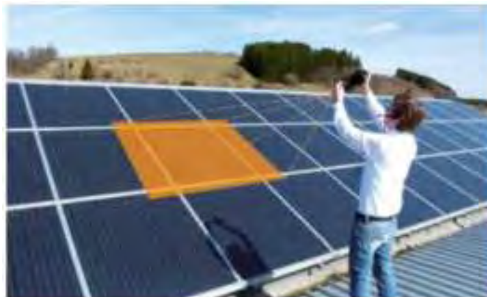
Figura 3-1. Orientación para medición de un módulo fotovoltaico.
