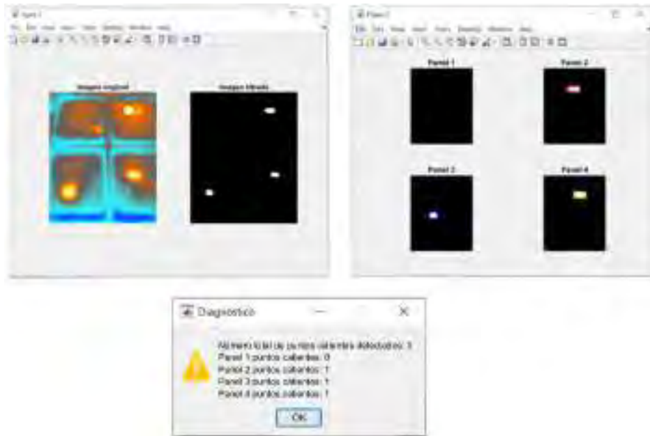
Figura 3-30. Paneles con puntos calientes a una irradiancia solar de 500 W/m 2 .
