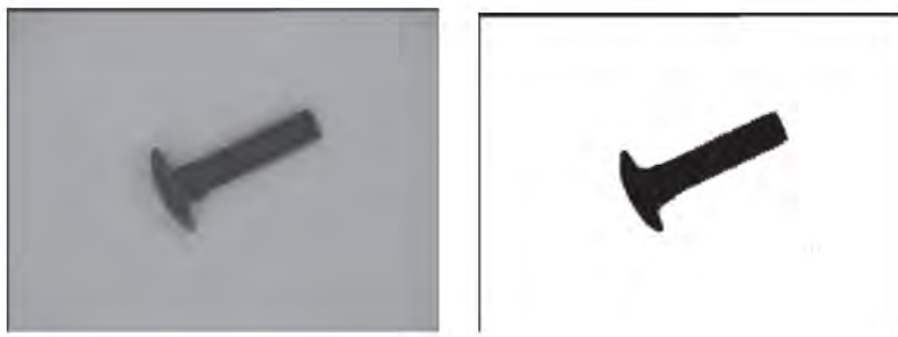
Figura 3-11. Ejemplo de umbralización por el método de Otsu.
