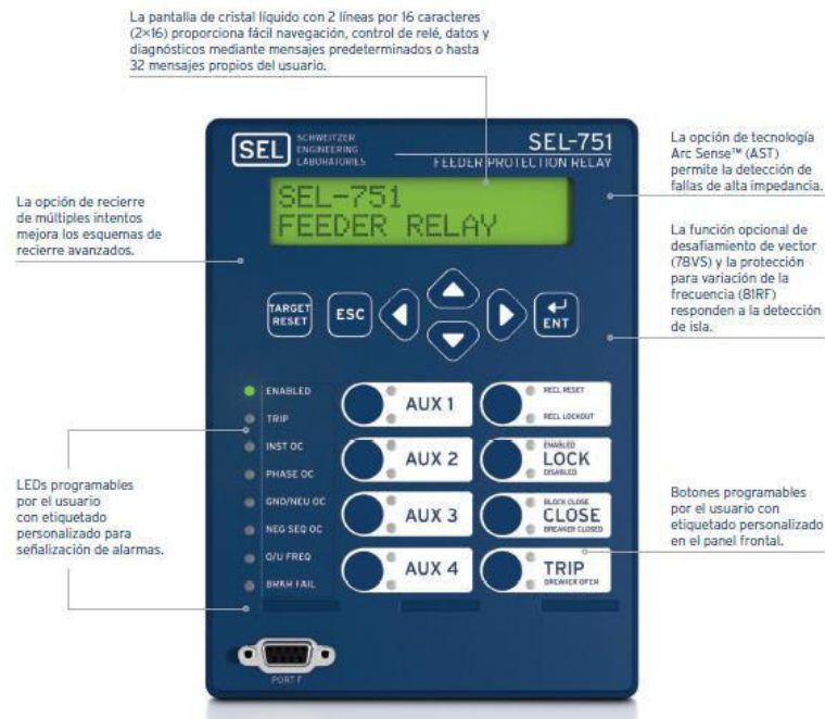
Figura 58 - Vista Frontal, Relé de protección SEL-751
