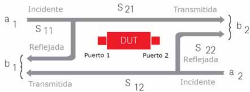
Figura A.1: Parámetros S de un dispositivo bajo prueba (DUT) Fuente: Adaptado de [35]
