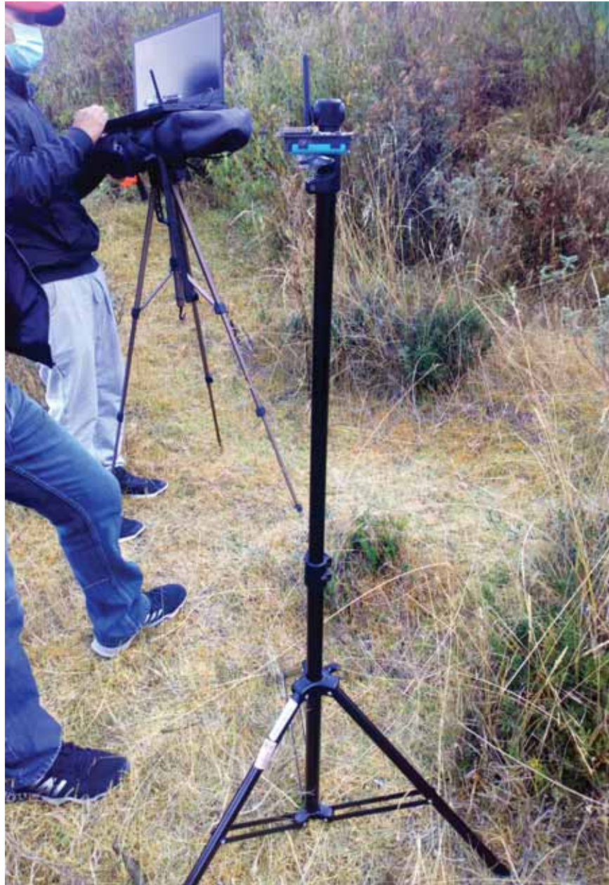
Figura 3.15: Sistema de adquisición de datos o sonda de canal
