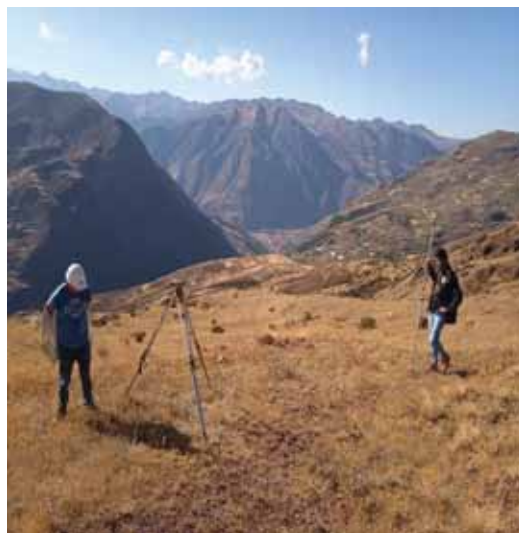
NIVELACION DE VUELTA 5+000 km A 6+000 km
