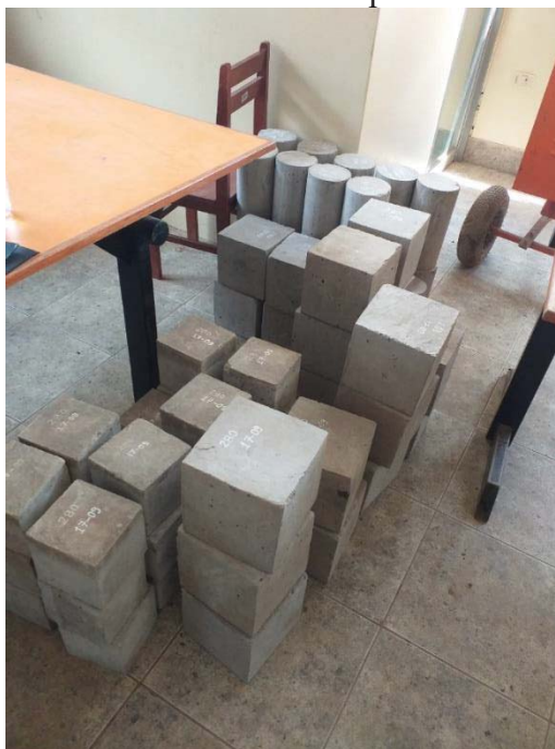
Figura 70. Traslado de las briquetas Cilíndricas y Cubicas al laboratorio para realizar el ensayo de resistencia a la compresión
