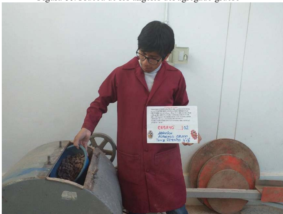
Figura 60. Prueba de los ángeles del agregado grueso
