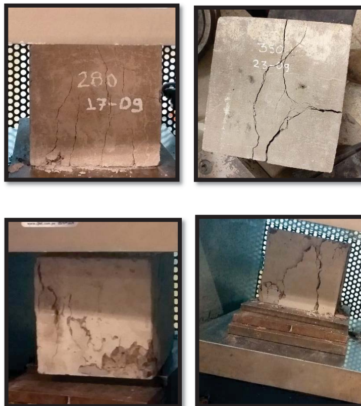
Figura 41. Fractura de briquetas cubicas
