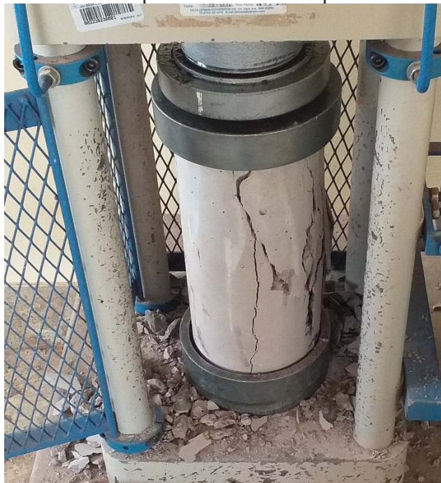
Figura 22. Falla de Tipo Columnar en briquetas Cilíndricas
