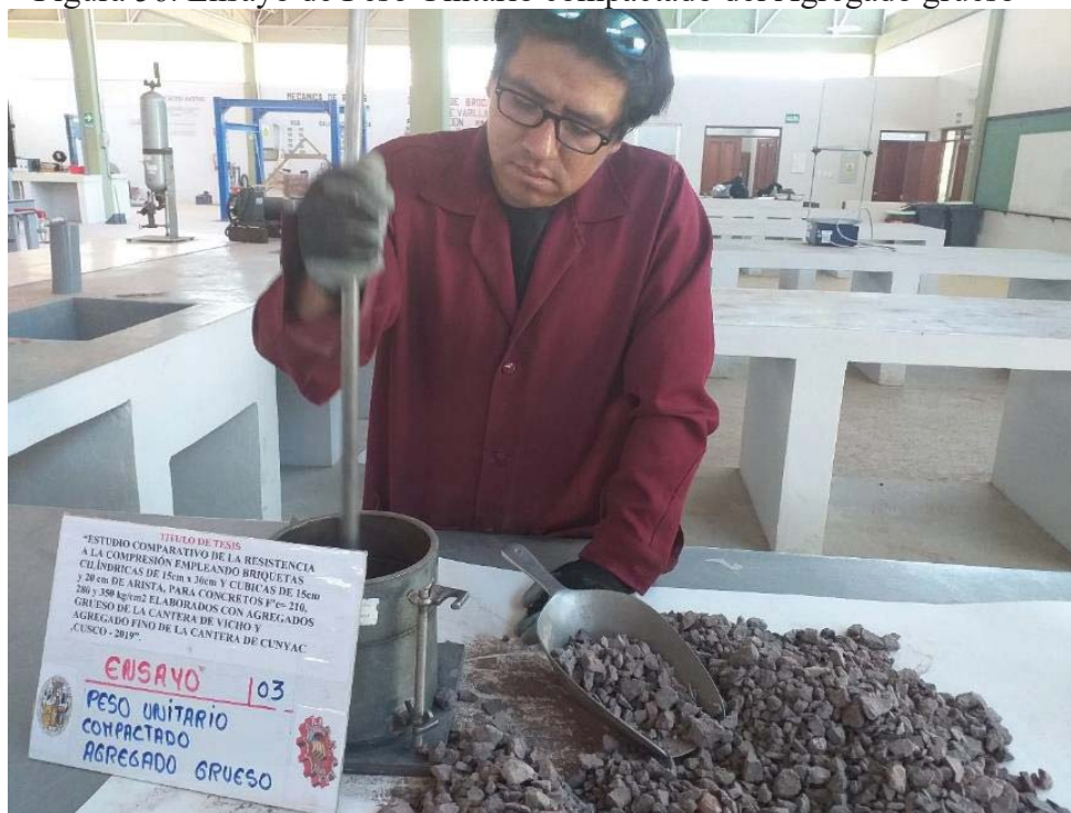
Figura 56. Ensayo de Peso Unitario compactado del Agregado grueso
