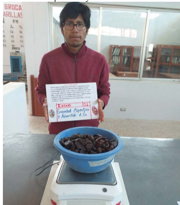
Figura 66. Agregado grueso saturado por 24 horas para realizar el ensayo de Gravedad Específica y absorción.
