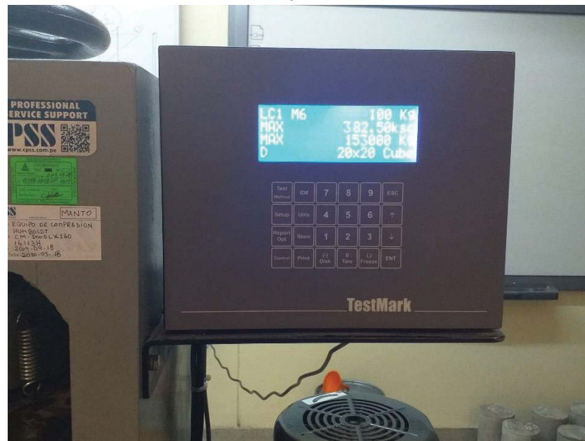
Figura 78. Lectura de resistencia a la compresión máxima alcanzada por una briqueta cubica de 20cm
