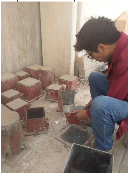
Figura 68. Desbriquetado de las briquetas Cilíndricas y Cubicas
