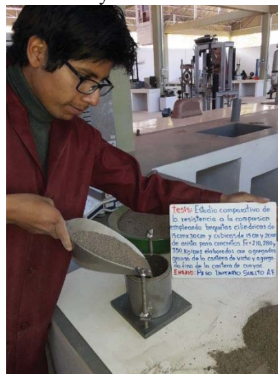
Figura 11. Ensayo: Peso unitario suelto
