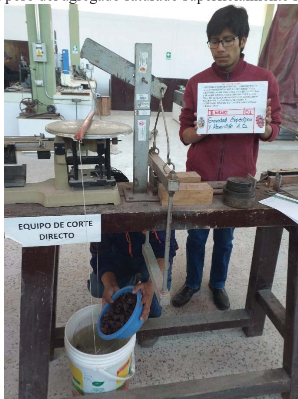
Figura 67. Obteniendo el peso del agregado saturado superficialmente seco sumergido en agua
