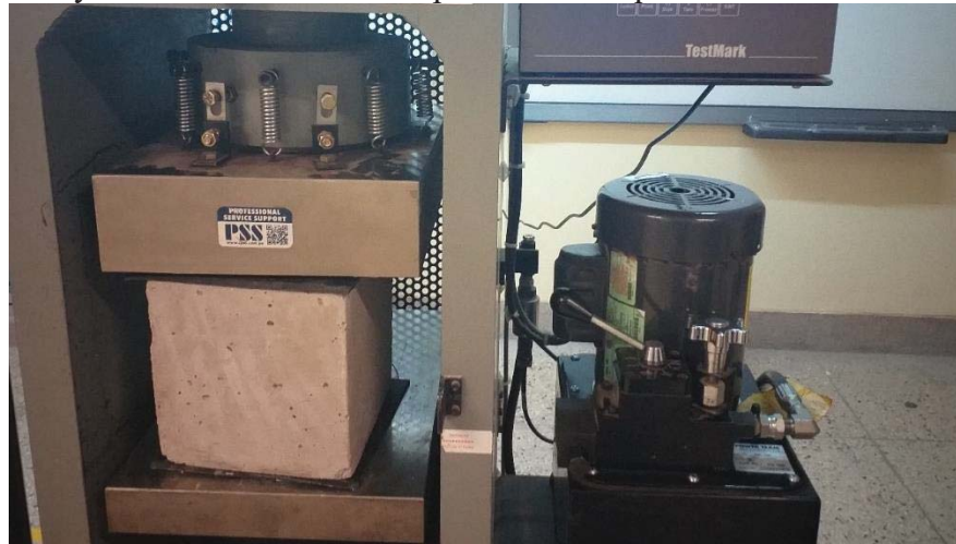
Figura 75. Ensayo de resistencia a la compresión de briquetas cubicas de 20cm de arista
