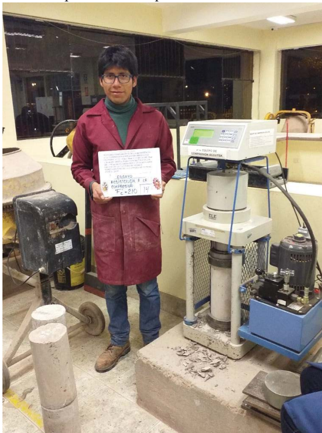
Figura 73. Ensayo a la compresión de briquetas Cilíndricas a los 28 días de vaciado
