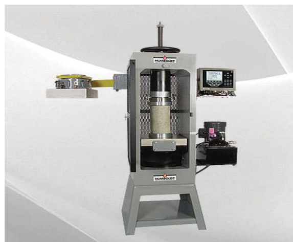
Figura 2. Maquina a la compresión modelo: HCM-5000Pi7P
