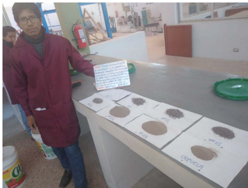
Figura 8. Ensayo: Granulometría del agregado Fino
