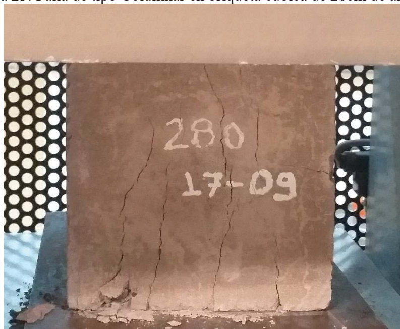
Figura 25. Falla de tipo Columnar en briqueta cubica de 20cm de arista
