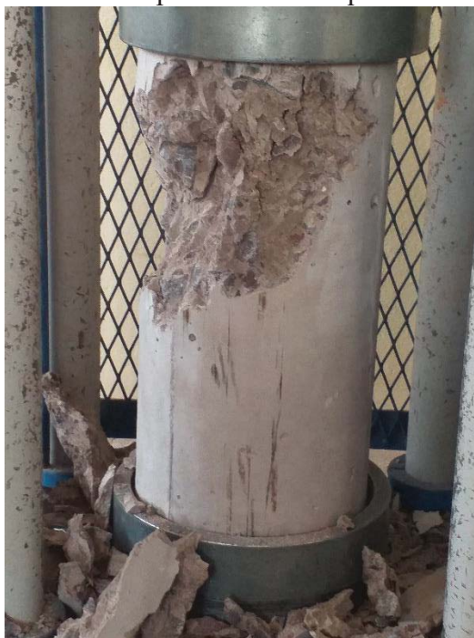
Figura 21. Falla de Tipo lateral en briquetas Cilíndricas
