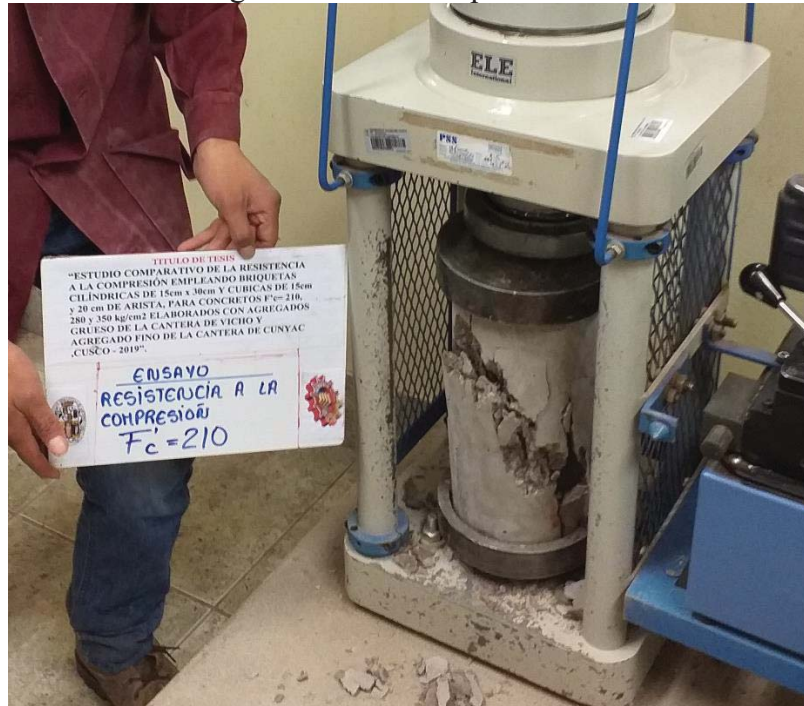
Figura 23. Falla de tipo Corte
