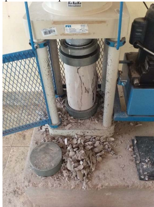
Figura 72. Ensayo a la compresión de briquetas Cilíndricas a los 28 días de vaciado, nótese que presenta un tipo de falla columnar.
