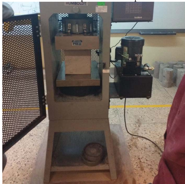
Figura 76. Ensayo de resistencia a la compresión de briquetas cubicas de 15cm de arista
