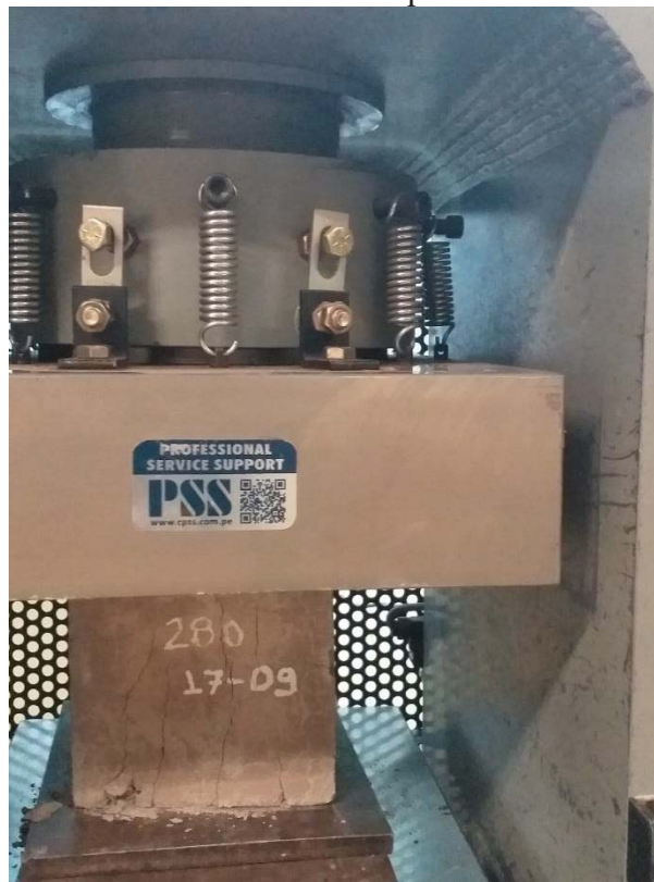
Figura 77. Falla por Fracturación extensional tipo columnar en briquetas cubicas.
