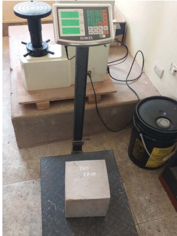
Figura 71. Pesado de briqueta Cubica de 20cm de arista
