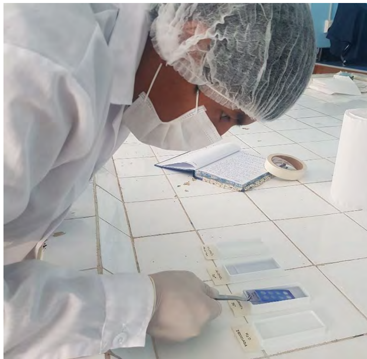
Foto 13. Inmersión de láminas de agarosa en solución de lisis (Halomax), agente reductor (Halomax) y etanol al 70° y 90°
