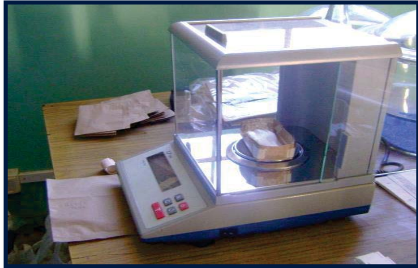
Foto N° 19. Pesado de muestra limpia de fibra de alpaca en el laboratorio de fibras del IVITA sede Maranganí.
