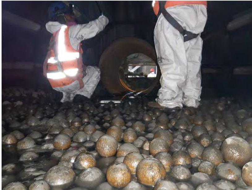
Figura 24. Inspección interna de Molino de bolas – Actividades de Alto Riesgo
