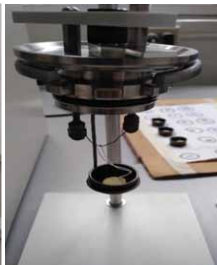
Anexo 13. Pesado del pellet y colocación del hilo de ignición unido con la muestra
