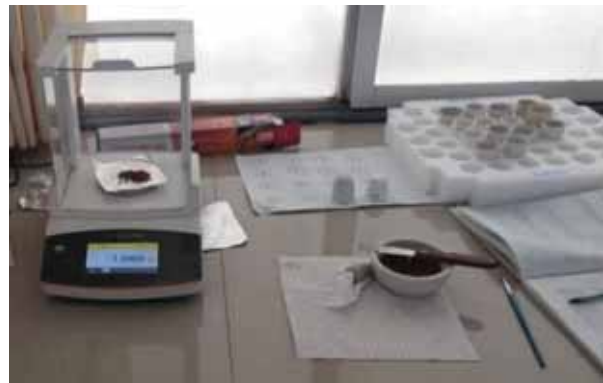
Anexo 13. Pesado del pellet y colocación del hilo de ignición unido con la muestra
