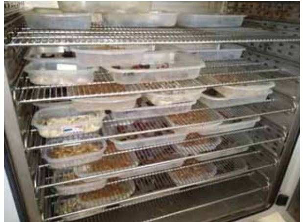
Anexo 9. Trozado de la carcasa y secado en estufa a 60°C
