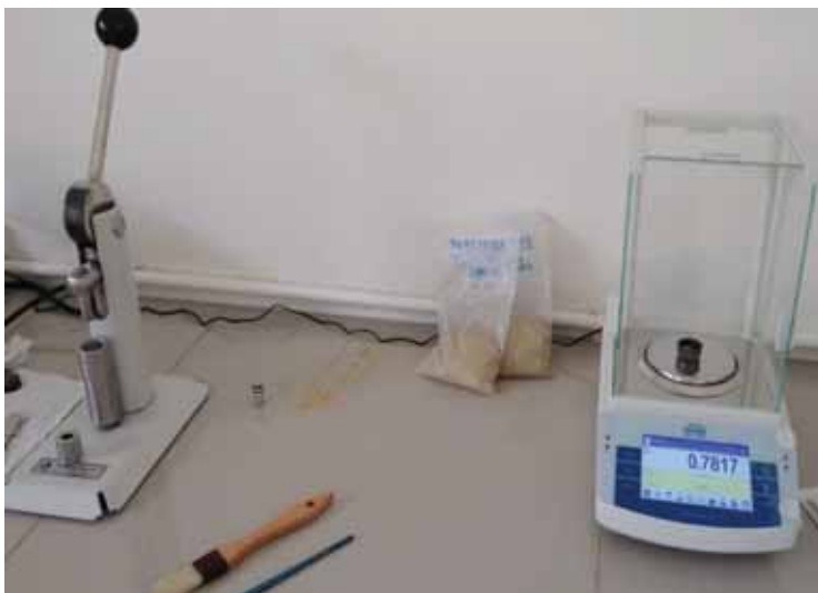
Anexo 13. Pesado del pellet y colocación del hilo de ignición unido con la muestra
