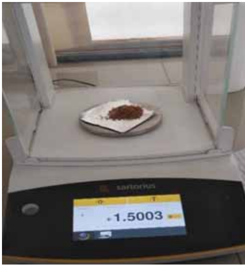
Anexo 12. Sacado de muestras procesadas de la Mufla y pesado en balanza analítica
