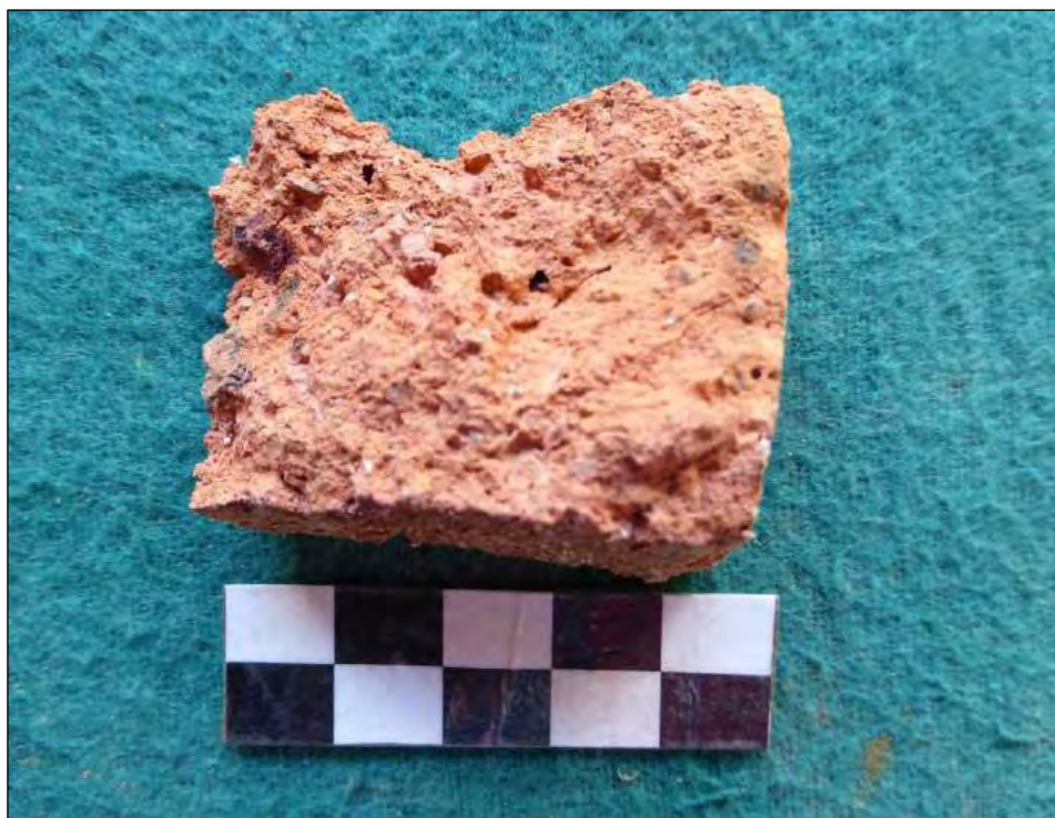
Figura 21: Ladrillo cochurado estable
