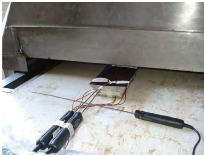
Foto H4. Empezando con las pruebas experimentales Sistema túnel /termómetro/envase con licor de cacao
