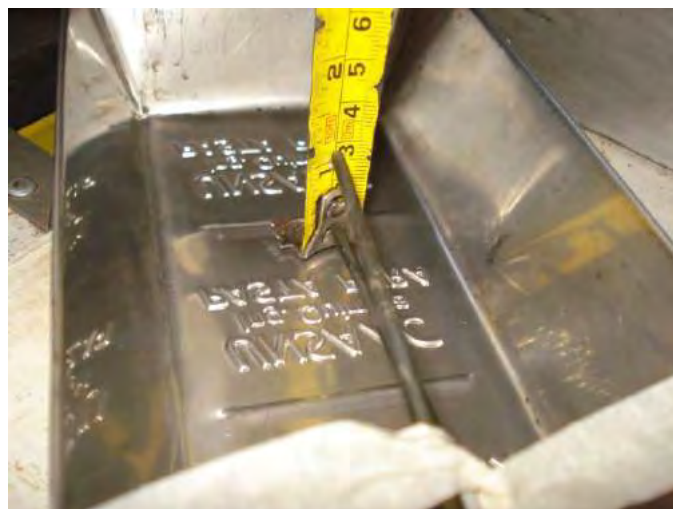
Foto H2. Tomando medidas al envase para ubicar terminales del termómetro
