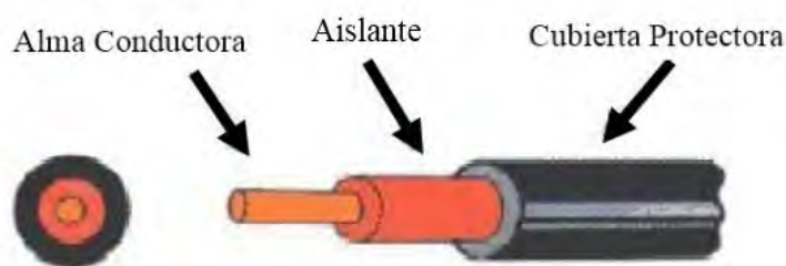
Figura 2-7 Partes de los Conductores. Fuente: Inacap.
