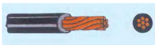
Figura 2-9 Conductor Eléctrico cuya alma está formada por un serie de hilos conductores.
