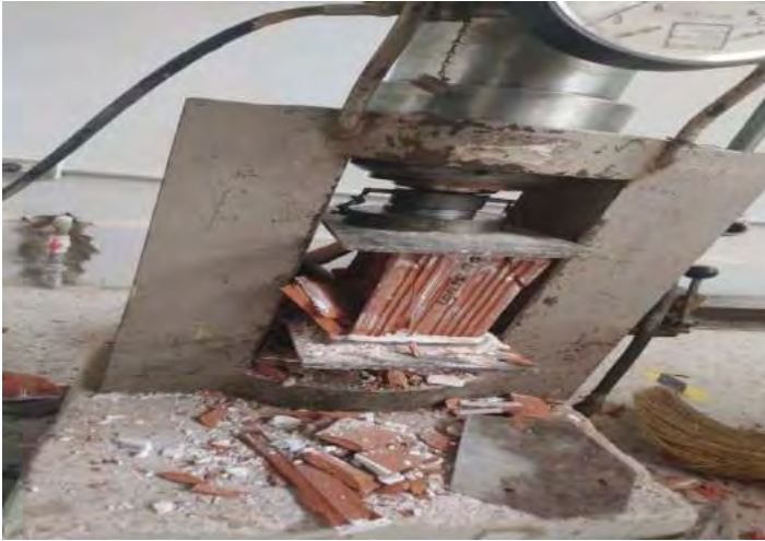
Compresión de unidades de ladrillo Blocker
