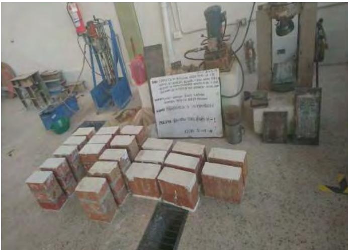
Pilas de ladrillos King Kong y Blocker listos para la respectiva prueba
