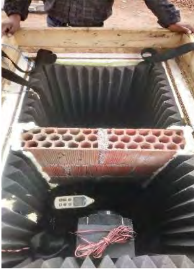
Figura 20. Cámara acústica por dentro con una muestra de muro representativo Fuente: Propia
