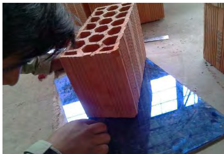
Medida del alabeo de canto en ladrillo Blocker Tradicional
