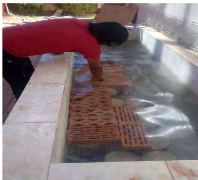
Poza usada para la prueba de absorción, como para la sumersión de los ladrillos antes de los asentados de muros y pilas
