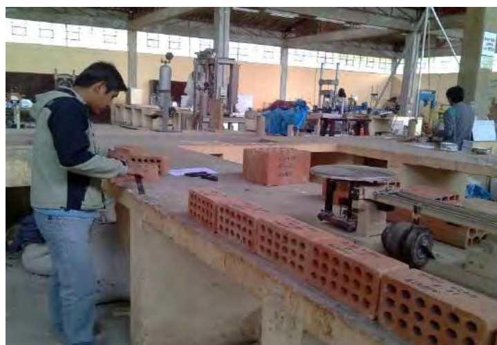
Realización de la prueba de variación dimensional en ladrillo King Kong Tradicional
