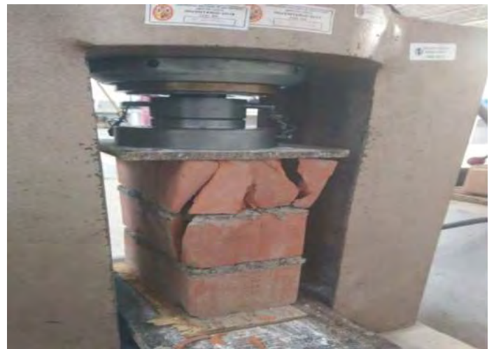
Compresión de pilas de tres unidades de ladrillo King Kong
