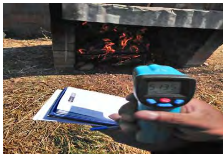
Toma de datos con el pirómetro de las temperaturas alcanzadas
