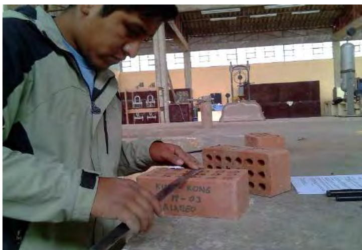
Medida del ancho del ladrillo King Kong Tradicional correspondiente a la prueba de variación dimensional
