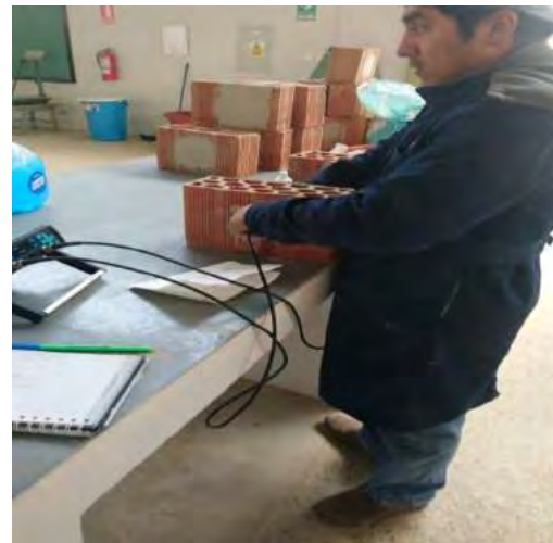
Realización de la prueba de ultrasonido y toma de datos
