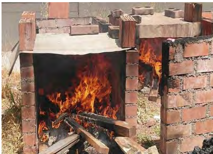
Simulación de un incendio para la prueba de resistencia al fuego
