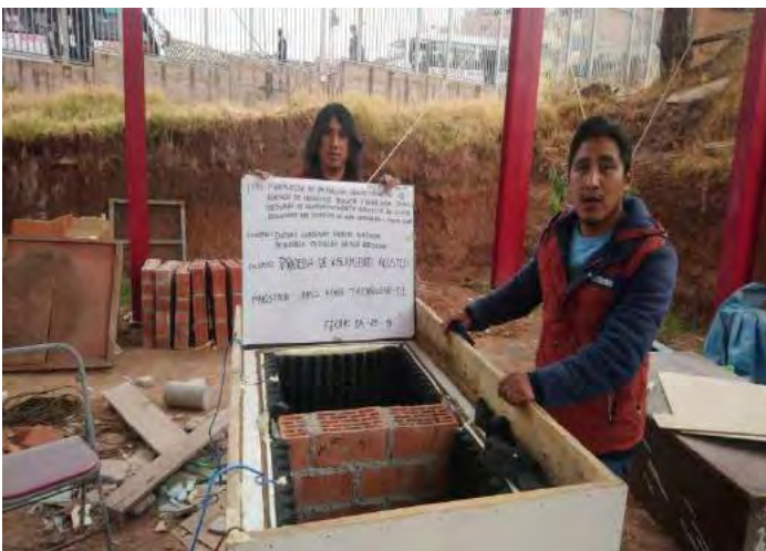
Posicionamiento del muro representativo en la cámara acústica.
