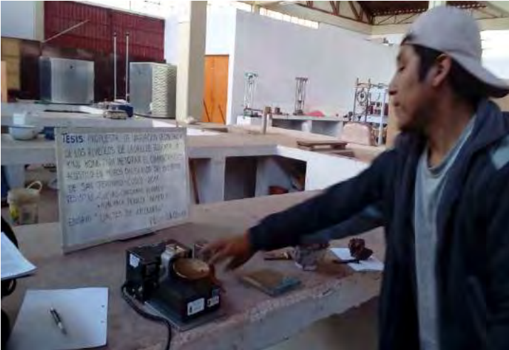
Ensayo de Limite liquido con uso de la cuchara de Casa Grande
