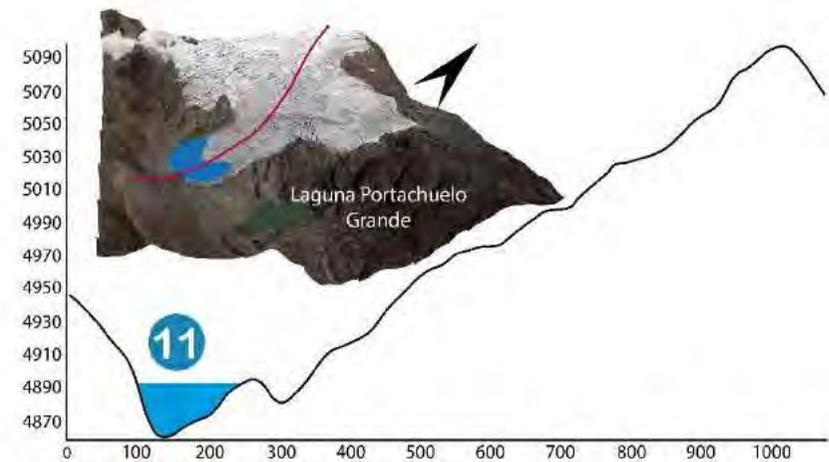
Figura 5.38: Muestra los perfiles topográficos basados en el DEMbasal calculados con GlabTop de las lagunas 7-11, acompañas de las imágenes satelitales de los glaciares del 2016 mostrando la zona de formación de lagunas. (Fuente: Elaboración propia)
