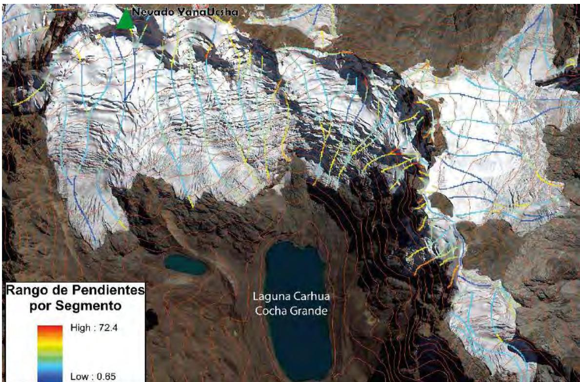
Figura 5.8. Ejemplo de los valores medios de pendiente por segmento de cada branch line. (Fuente elaboración propia).
