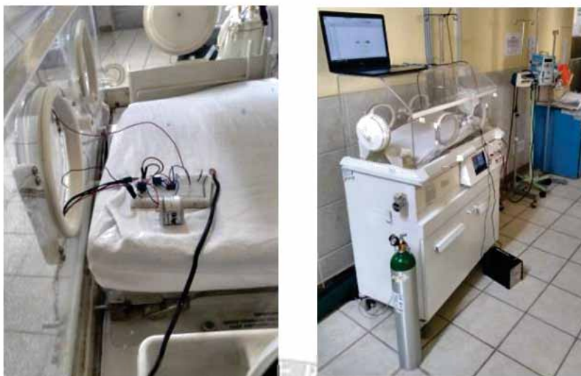
Figura 36: Instalación del sistema DAQ en la incubadora neonatal
