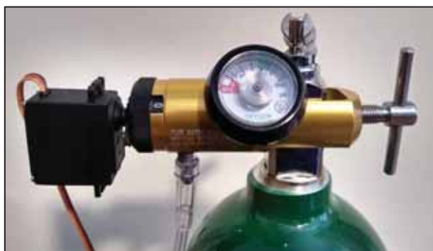
Figura 26: Actuador del sistema de control (Servomotor acoplado al regulador tipo Yugo)
